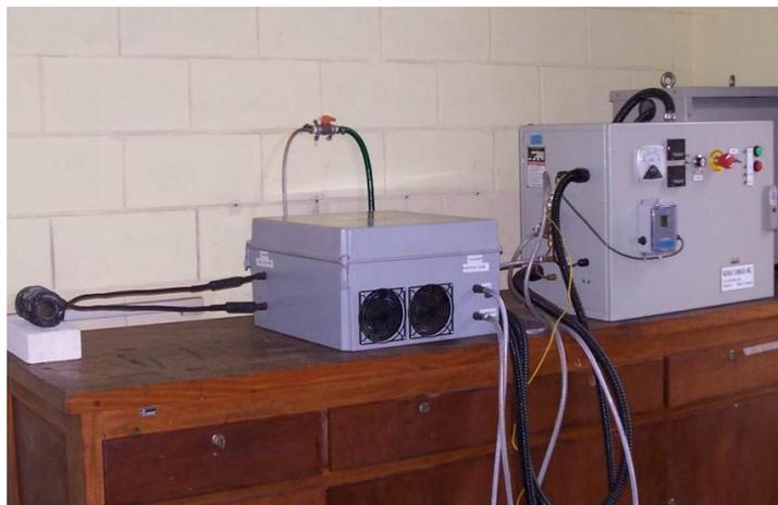
Figura 3.5: Forno indutivo utilizado nos tratamentos térmicos de globularização. (Adaptado de Torres, 2009).
