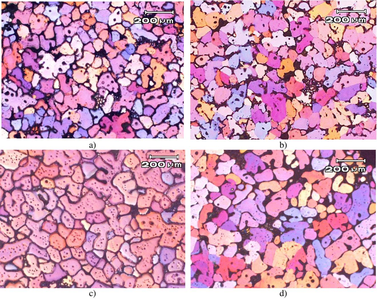
Figura 4.7: Metalografia colorida da liga tixoforjada Al-4,0wt%Si-2,5wt%Cu tratada termicamente para 45%fs e 60%fs nos tempos de tratamento em 0s e 210s. a) fs45% 0s, (b) fs60% 0s, (c) fs45% 210s e (d) fs60% 210s.
