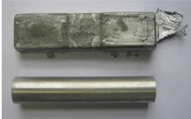
Figura 4.18: Peça inicial obtida nos ensaios de tixoforjamento para comparação das medidas finais, amostra antes de ser tixoforjada e após o ensaio. (NALDI 2011).
