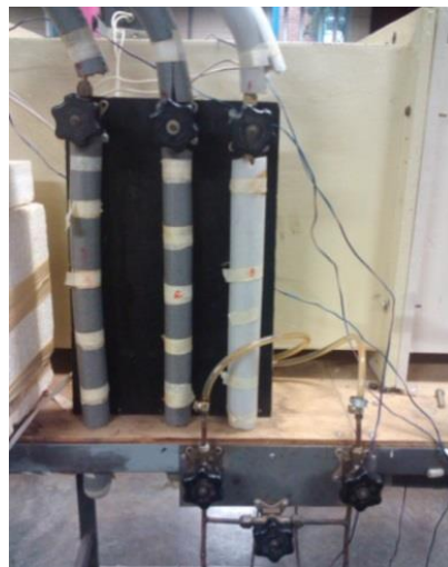
Figura 3.5: Arranjo das válvulas de gaveta em cada linha de fluxo.
