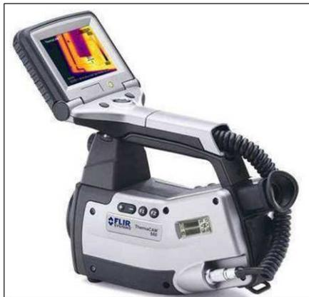
**Figura 26 - Termo-câmara utilizada para medir a temperatura de corte.**
