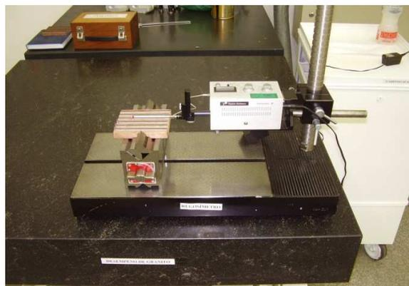
**Figura 28 - Sistema especialmente montado para realização das medidas da rugosidade das superfícies fresadas.**
