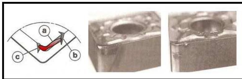
**Figura 31 - Ilustrações do desgaste de flanco (a) e dos desgastes de entalhe (b) e (c). Fotos de insertos com os desgastes mencionados. (Diniz et al., 2013).**
