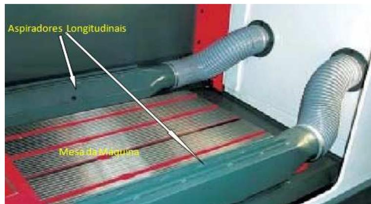
Figura 23. Este sistema, existente na máquina como um acessório, leva todo o produto da usinagem para um reservatório apropriado instalado externamente ao ambiente de trabalho.
