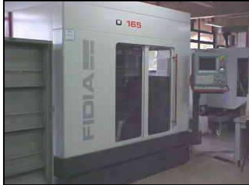
**Figura 22 - Centro de Usinagem FIDIA D165 utilizado nos ensaios.**
