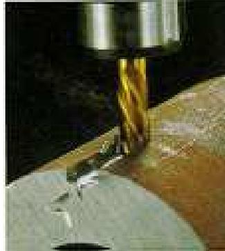
**Figura 29 - Operação de fresamento com uma fresa atuando como fresa de topo e cilíndrica tangencial com dentes helicoidais. (Diniz et al., 2013).**
