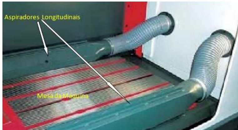
**Figura 23 - Sistema de aspiração e remoção dos pós de PRFC gerados durante a usinagem.**
