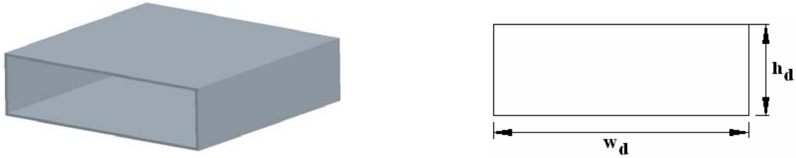
Figura 4.1 – Geometria do modelo duto retangular (DR)
