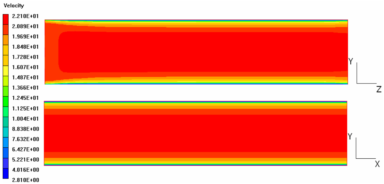
Figura 5.10 – Distribuição de velocidades nos planos Y-Z e Y-X para um escoamento turbulento nas posições ( X = 0 e Z = 0 ).
