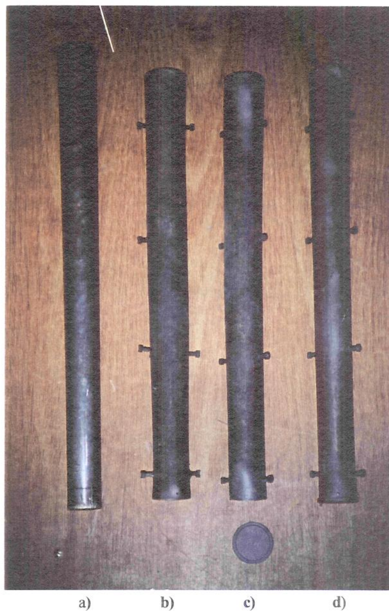
FIGURA 4.15 – Vista mostrando: o macho utilizado na construção das lingoteiras (a); duas lingoteiras desmontadas e o fundo tampão abaixo (b) e (c) e uma Lingoteira Completa (montada) (d).
