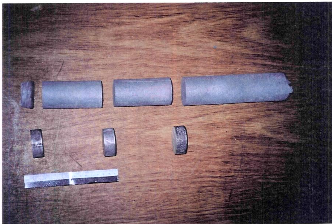
FIGURA 5.2 – Produto resultante do lingotamento semi-contínuo e sob agitação eletromagnética no equipamento projetado e construído: um lingote com aproximadamente 450 mm na altura e diâmetro mínimo de 45 mm.
