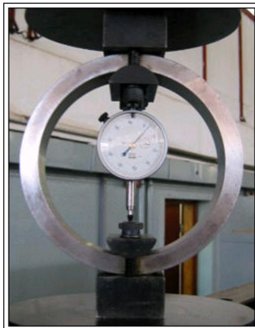
**Figura 5.56: Anel padrão utilizado na calibração da força**
