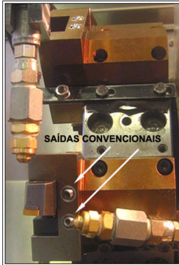
Figura 4.5: Montagem dos injetores do fluido de corte
