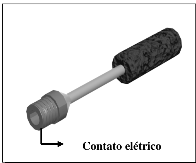
Figura 3.2. Eletrodo cilíndrico de CVR de 60 ppi usado para a eletrogeração de peróxido de hidrogênio.
