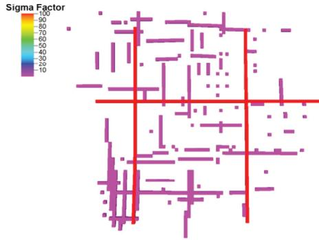
Figura 4-14: Vista superior da distribuição das fraturas de alta permeabilidade e selantes.
