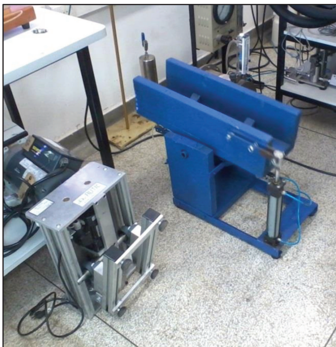
Figura 58. Aparatos utilizados para agitação do cilindro com a solução salina carbonatada.
