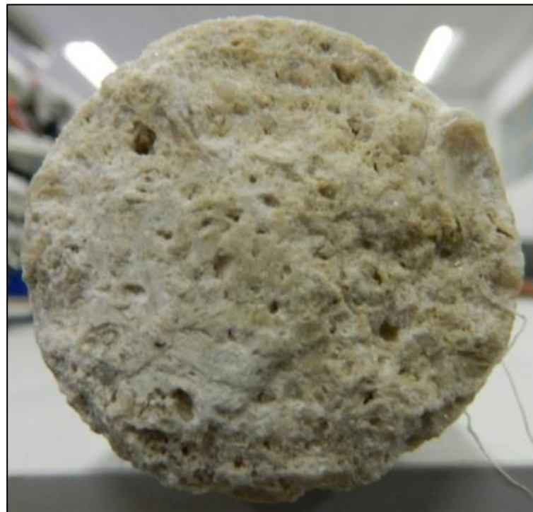
Figura 127. Face de produção da coquina (A) após todos os testes mostrando algumas regiões danificadas.
