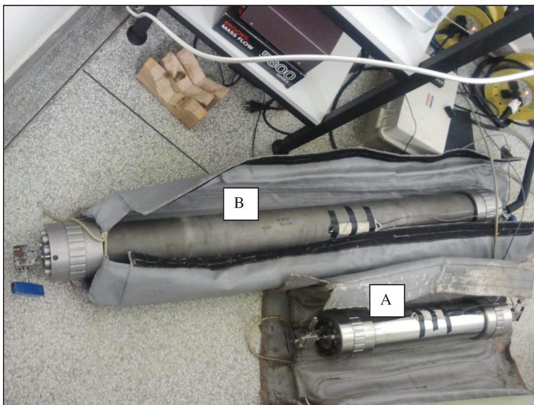
Figura 57. Cilindros e mantas de aquecimento utilizadas para carbonatar a salmoura (cilindro B) e para a etapa de drenagem (cilindro A) no teste a 65°C.
