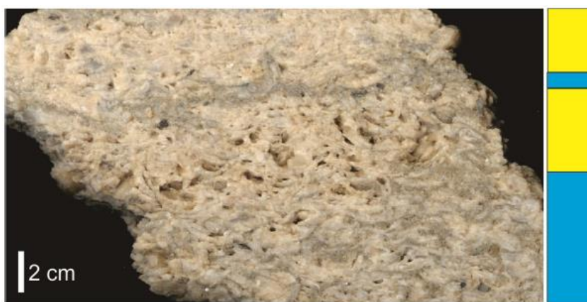
Figura 7. Amostra selecionada para descrição geológica, marcadas por diferenças nos tamanhos dos bioclastos e no conteúdo de lama. A cor azul indica maior conteúdo de lama e menor porosidade, enquanto que a cor amarela indica menor conteúdo de lama e maior porosidade Dal'Bó (2012).
