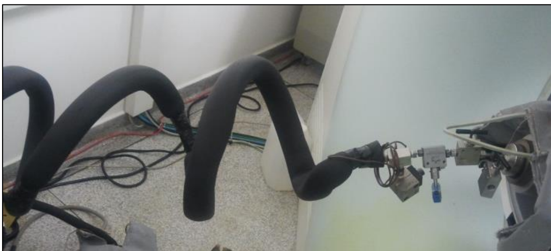
Figura 36. Conexão entre a serpentina e o sistema de injeção do aparato (A).
