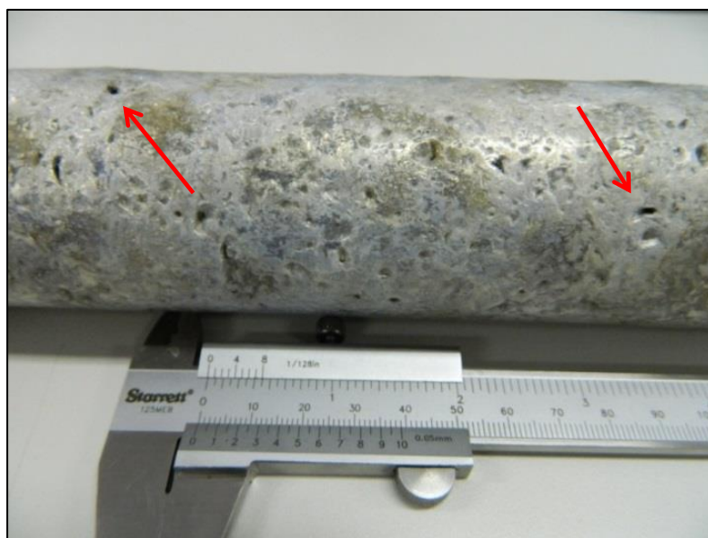
Figura 124. Coquina (A) após todos os ensaios bifásicos. As setas vermelhas mostram a borracha, utilizada para aplicar a sobre pressão, aderida juntamente com o material termo retrátil em poros vulgares da rocha.
