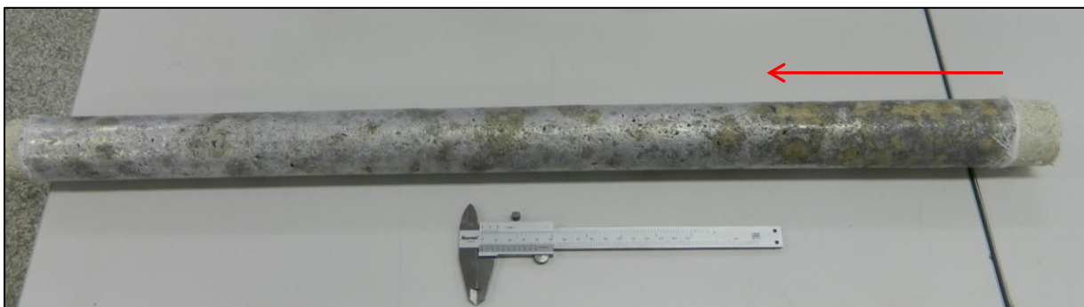
Figura 123. Coquina (A) parcialmente revestida com papel alumínio e totalmente revestida com material termo retrátil. A seta vermelha indica o sentido de injeção.
