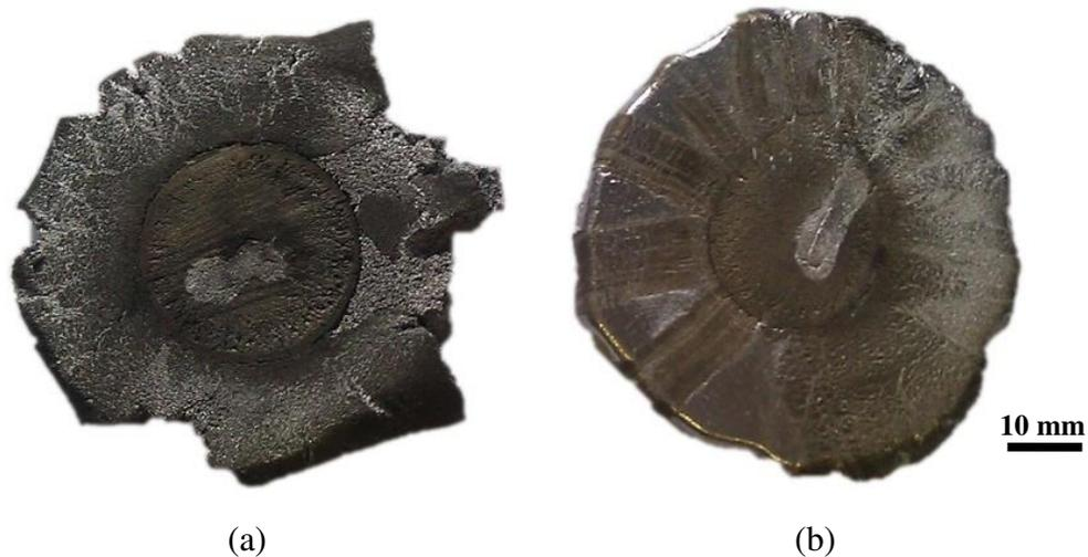
**Figura 4.24:** Macrografias típicas de amostras após a compressão a quente com microestrutura: (a) dendrítica e (b) globular.
