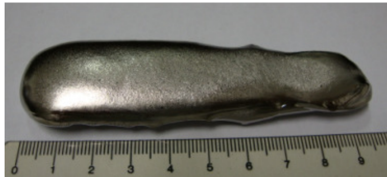
Figura 3.2. Lingote de 100g da liga Ti-35Nb-7,5Ta após a fundição [cm].
