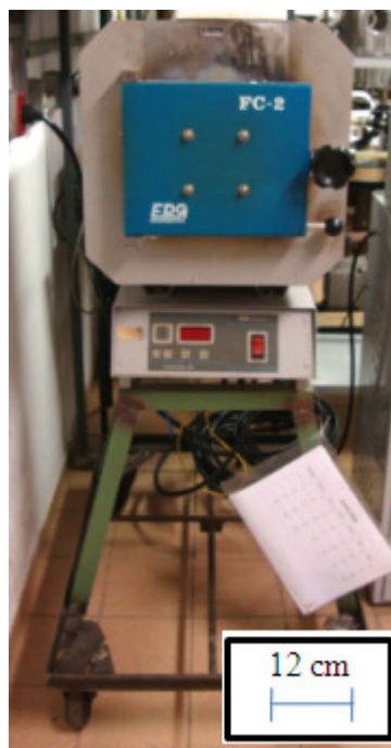
Figura 3.3. Forno de aquecimento resistivo que foi utilizado no tratamento térmico das amostras da liga Ti-35Nb-7,5Ta.
