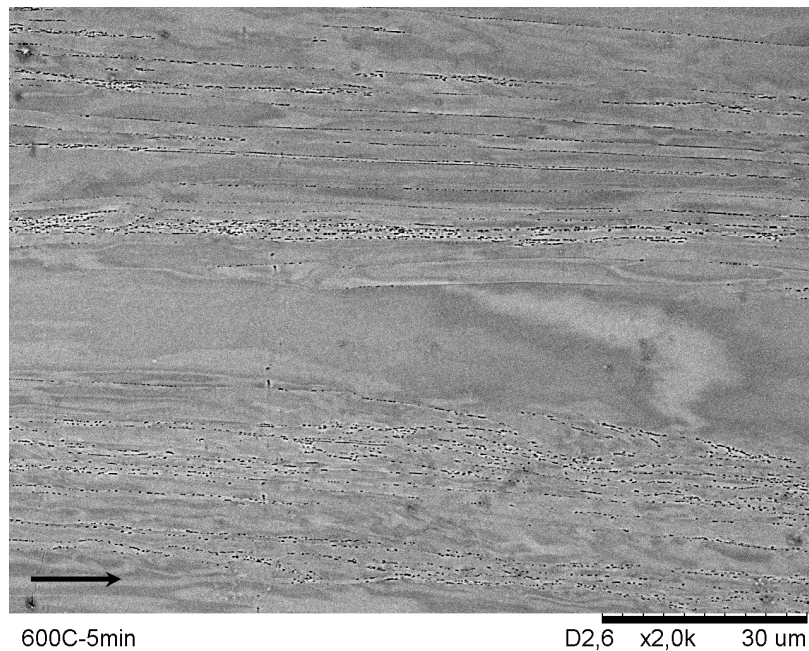
Figura 4.15. Micrografias da amostra Ti-35Nb-7,5Ta laminada a frio até 84%, recozida a 600°C durante 5 minutos (MEV, elétrons retroespalhados). A seta indica a direção de laminação.
