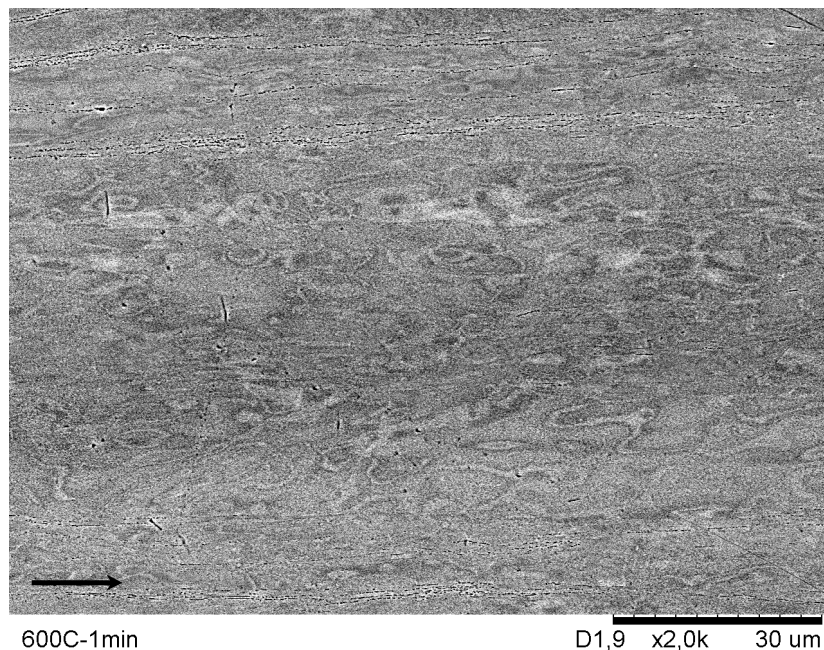
Figura 4.14. Micrografias da amostra Ti-35Nb-7,5Ta laminada a frio até 84%, recozida a 600°C durante 1 minuto (MEV, elétrons retroespalhados). A seta indica a direção de laminação.
