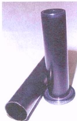
Figura 4.9. Tubos de quartzo (esquerda) e alumínio (direita) revestidos interna e externamente com DLC.
