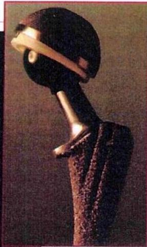
Prótese de joelho (à esq.) imersa no plasma e de quadril (acima) revestida com DLC
