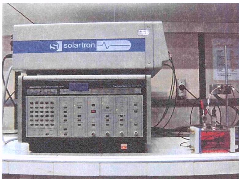
Figura 3.8. Célula de corrosão montada com solução de Hanks (superior); e equipamento utilizado nos ensaios.
