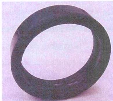
Figura 4.8. Sede de rolamento revestido com DLC
