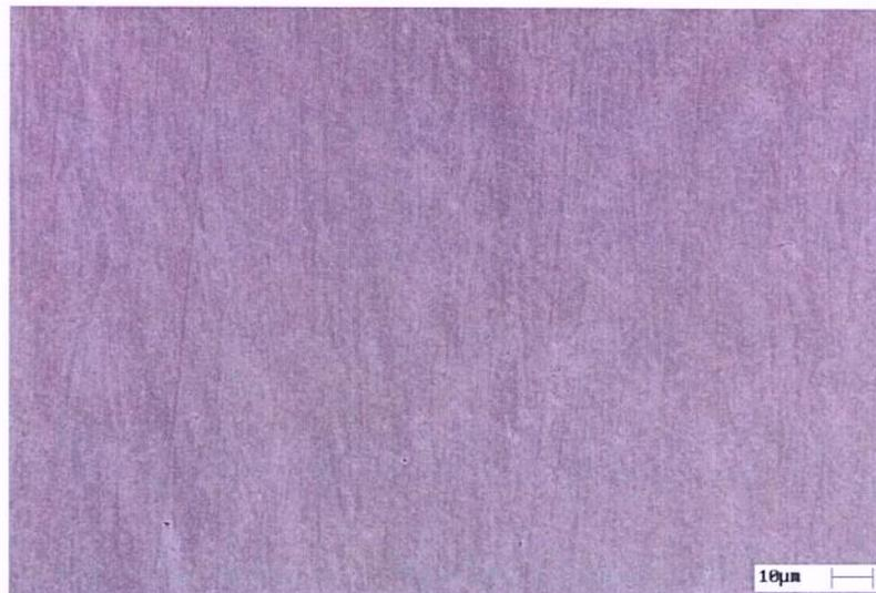
Figura 4.17. Imagem por MEV da superfície do revestimento de DLC depositado sobre Ti-13Nb-13Zr. Barra = 10  $\mu\text{m}$ . Aumento original 1500X.
