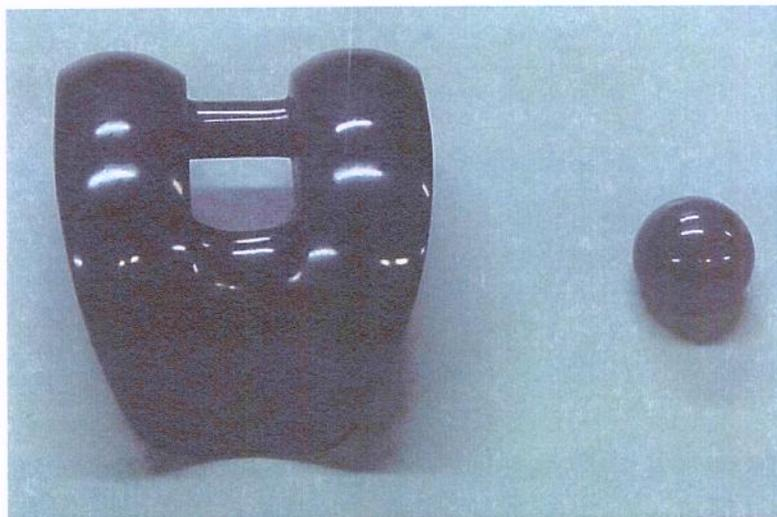
Figura 4.1. Implantes de joelho e cabeça femoral de Co-Cr-Mo revestidos com DLC.
