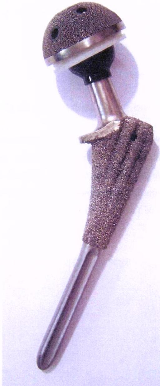
Fig. 4.2. Implante de quadril, não cimentado, de Ti-13Nb-13Zr: cabeça femoral com revestimento de DLC, acetábulo com revestimento de microesferas e haste femoral com revestimento de “plasma spray” a vácuo. Combinação de módulo de elasticidade mais próxima ao do osso (liga de titânio) e revestimento resistente ao desgaste na articulação (DLC).
