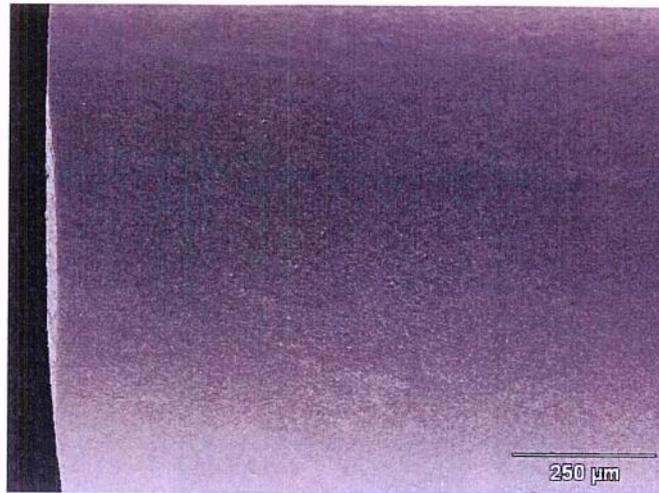
Figura 4.20. Imagem por MEV da superfície do pino revestido com DLC. Aumento original: 100X.
