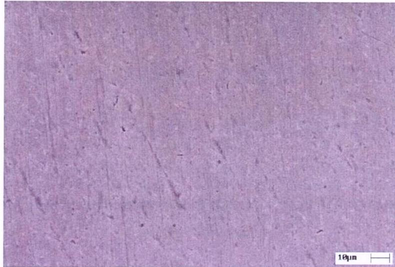
Figura 4.16. Imagem por MEV da superfície da liga Ti-13Nb-13Zr. Barra = 10  $\mu\text{m}$ . Aumento original 1500X.
