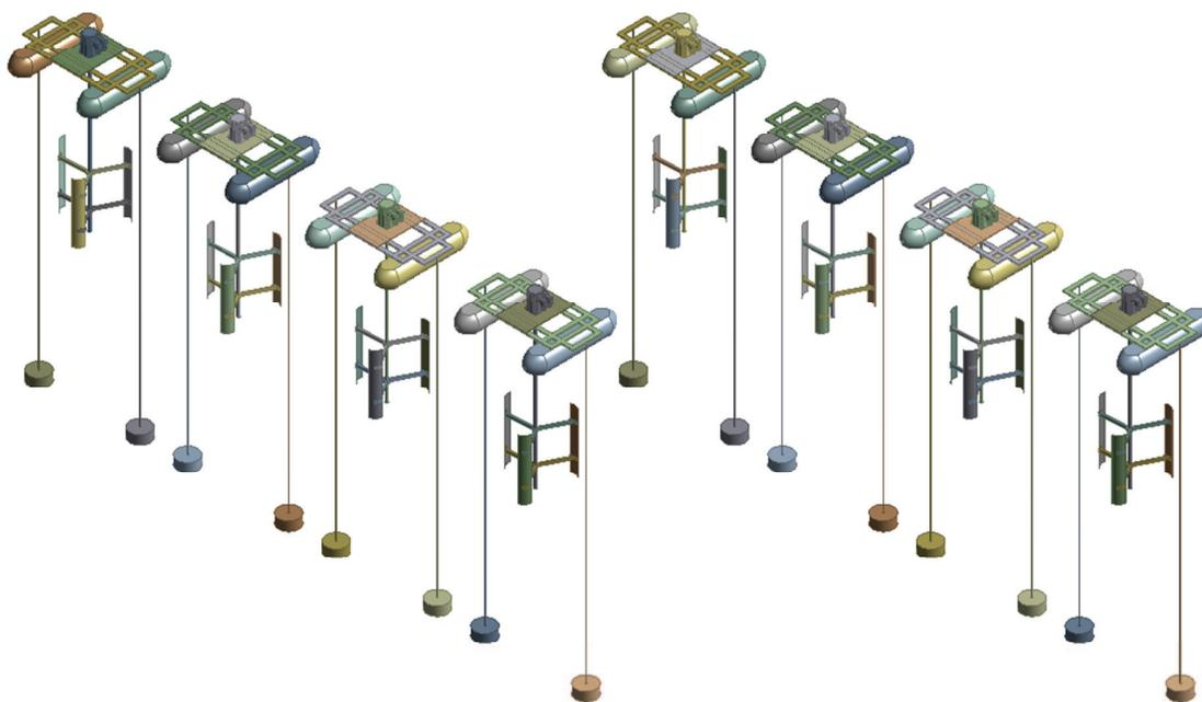
Figura 6.4 - Matriz descentralizada para geração de energia através de correntezas.
