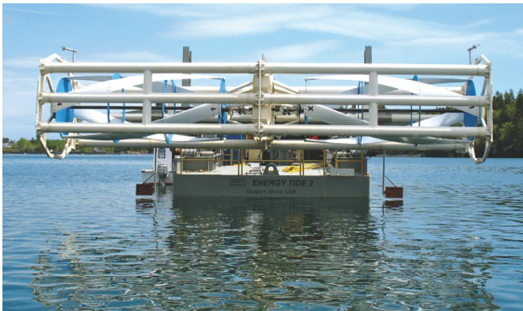
Figura 1.5 - Beta Turbine Generator Unit, o maior dispositivo de conversão de energia marinha já desenvolvido nos EUA da ORPC (Ocean Renewable Power Company's). (DOE – US Department of Energy)
