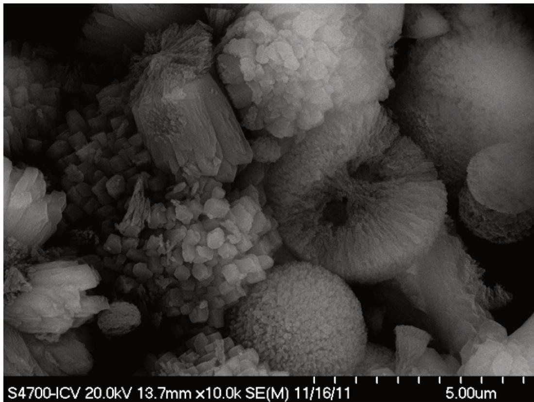
Figura 4.6: Microscopias eletrônicas de varredura do carbonato de cálcio em diferentes aumentos.
