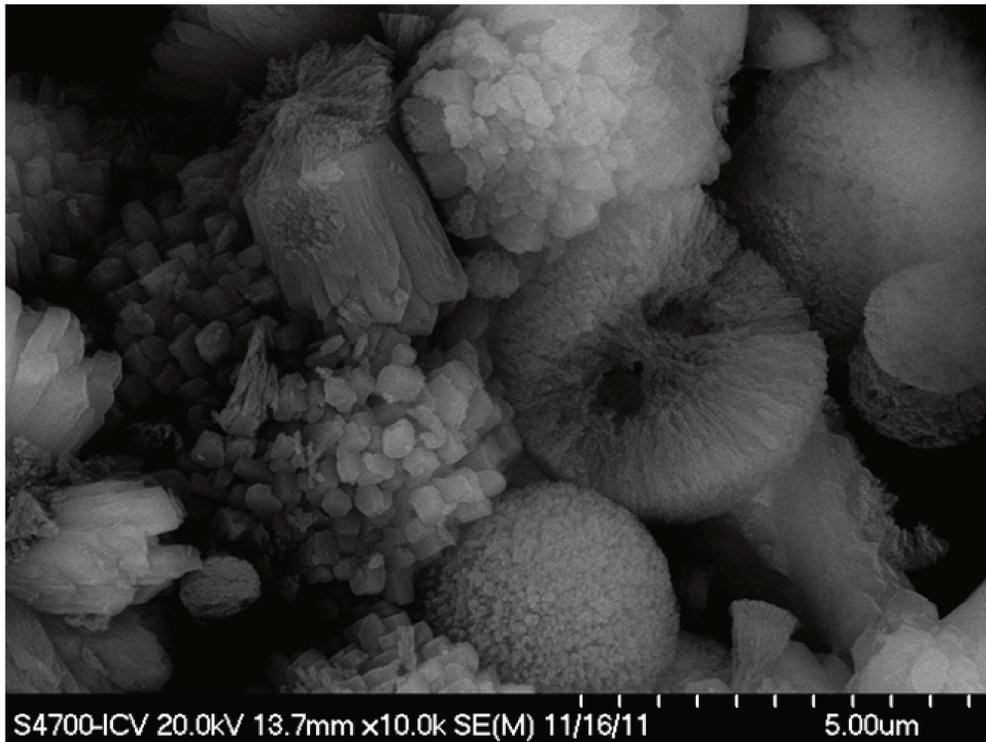
Figura 4.13: Microscopia eletrônica de varredura do carbonato de cálcio antes e após moagem.
