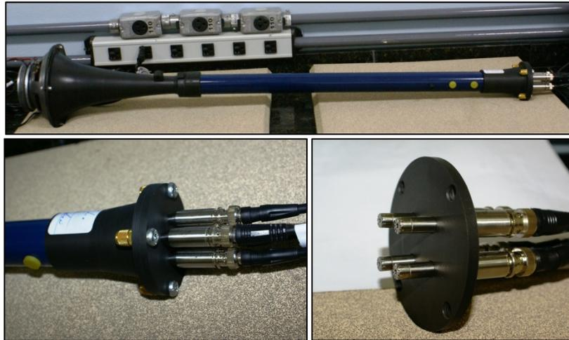
**Figura 4.13 – Montagem para calibração de fase.**
