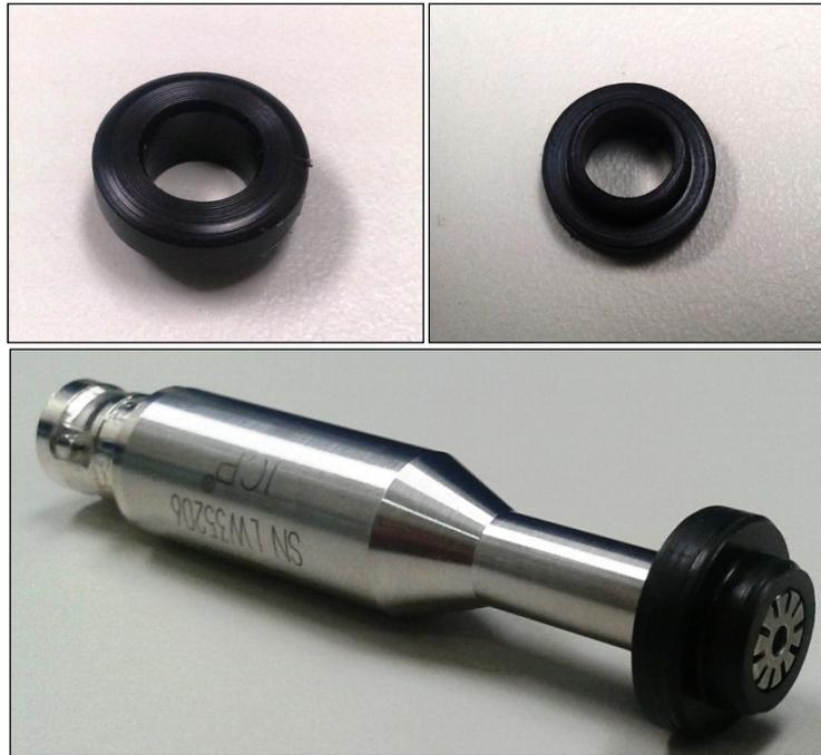
**Figura 4.4 – Adaptador do microfone no tubo.**
