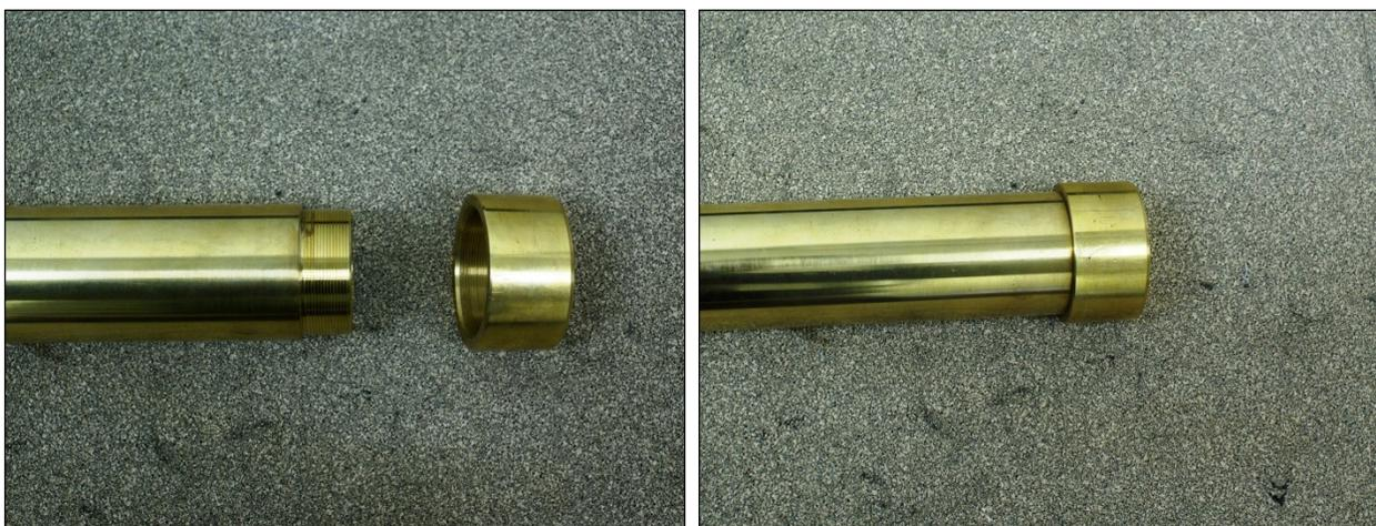
**Figura 4.10 – Fotos da terminação rígida em latão – Desmontada a esquerda e montada a direita.**
