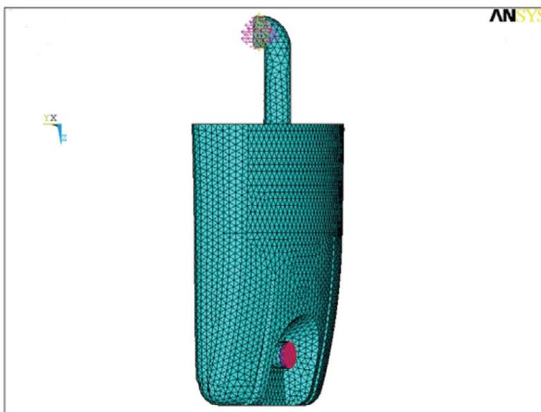
**Figura 2.23 – Cavidade do Coletor de Admissão modelado, Nuñes *et al* (2008).**
