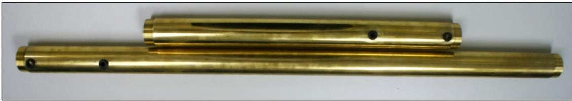
**Figura 4.8 - Foto dos tubos de latão utilizados, tubo de inserção acima e saída abaixo.**
