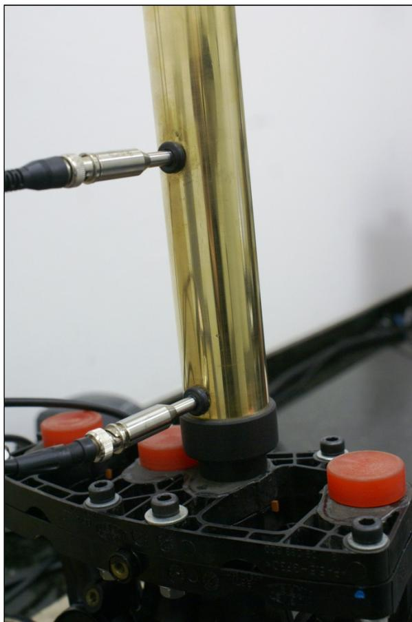
**Figura 4.6 – Detalhe da montagem dos microfones no tubo de saída.**
