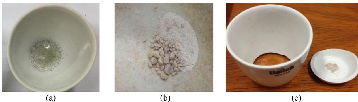
Figura 4.1 – (a) Cinzas fundidas no cadinho, (b) incrustações de alta dureza, (c) incrustação num cadinho quebrado.
