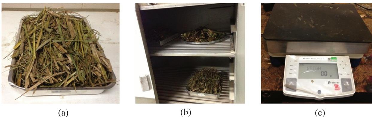
Figura 3.3 – Secagem da palha de cana de açúcar. a) bandejas com amostras, b) bandejas dentro da estufa e c) balança OHAUS Explorer.
