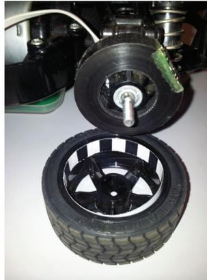
Figura C.1: Resposta do encoder incremental nas 4 rodas
