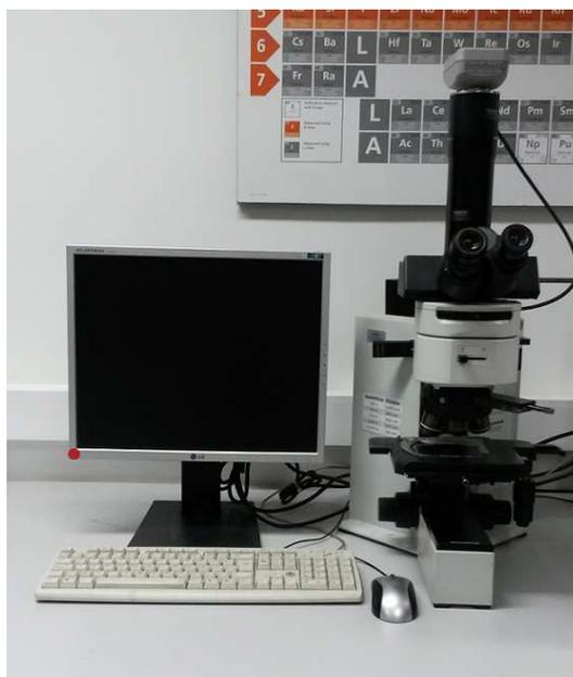
Figura 3.6: Microscópio óptico Olympus BX60M.
