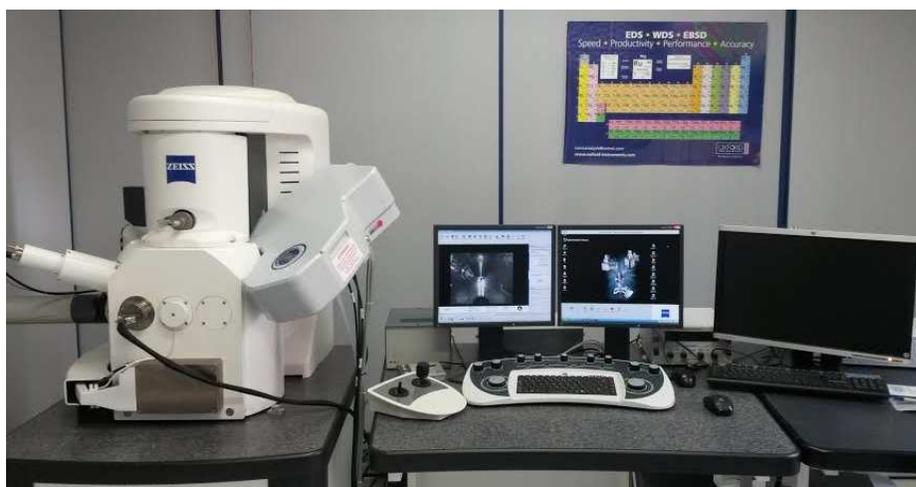
Figura 3.7: Microscópio Eletrônico de Varredura EVO-MA15, marca Zeiss.
