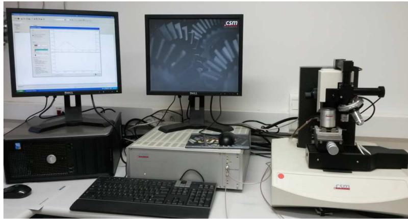
Figura 3.9: Equipamento de nanoindentação instrumentada da marca CSM Instruments, modelo TTX-NHT.
