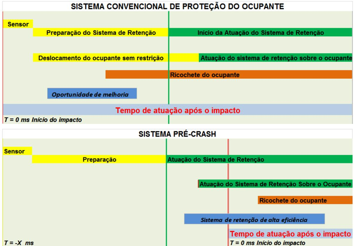
Figura 4.4 Comparativo pré-crash x método convencional em segurança passiva.
