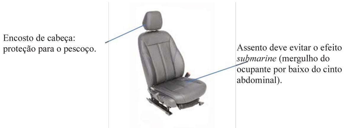
Figura 3.13 Exemplo de assento dianteiro com encosto de cabeça.
