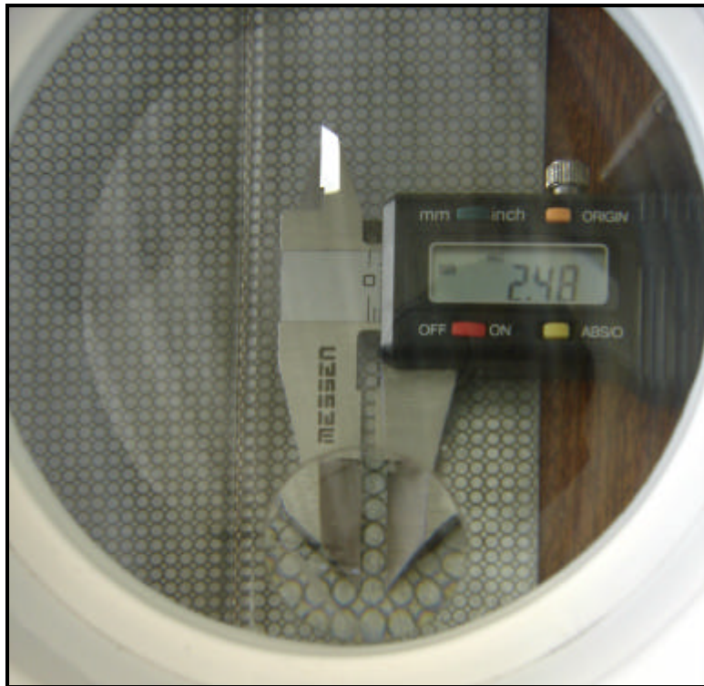
Figura 4.11 – Medições das Deformações com o Paquímetro Digital
