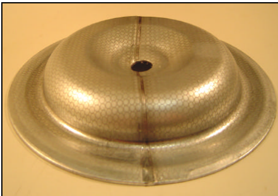
Figura 4.17 – Forma Final da Peça Estampada com Raio de 13,5mm
