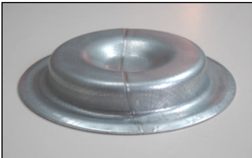
Figura 3.20 – Forma Final da Peça Estampada com Raio de 5mm
