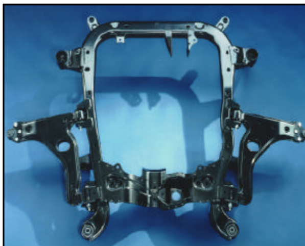
Figura 2.23 – Exemplo de Berço de Apoio do Modelo Zafira (extraída de HERTELL, 2001).
