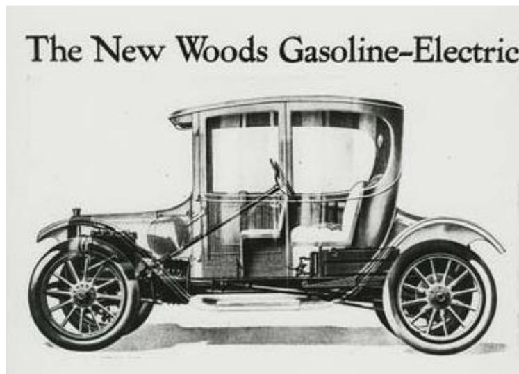
Figura 2.2: Woods Gasoline-Electric com MCI e ME na dianteira acoplados a um Eixo Cardan e diferencial, transmitindo tração para eixo traseiro. Baterias se encontram debaixo dos bancos traseiros. (GLINTON, 2012)
