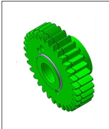
Figura 1.2 – Engrenagem com sistema de redução de folgas
