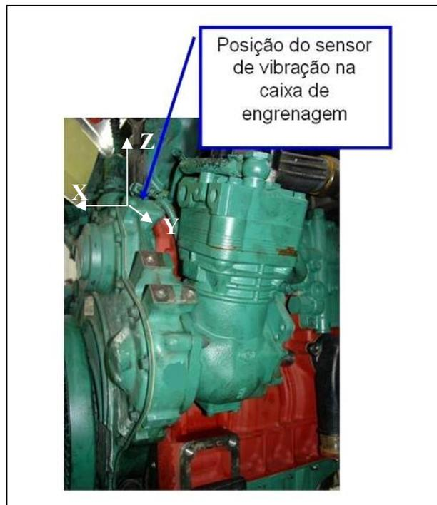
Figura 3.6.1 – Posicionamento do acelerômetro na caixa de engrenagens
