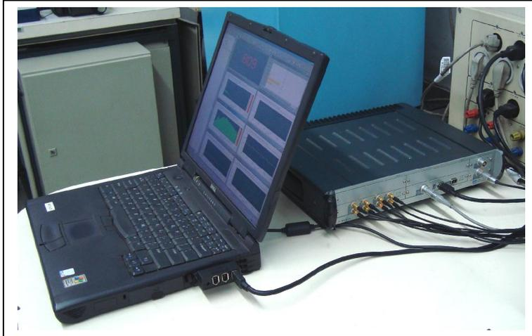
Figura 3.6.4 – Analisador de vibrações Pimento
