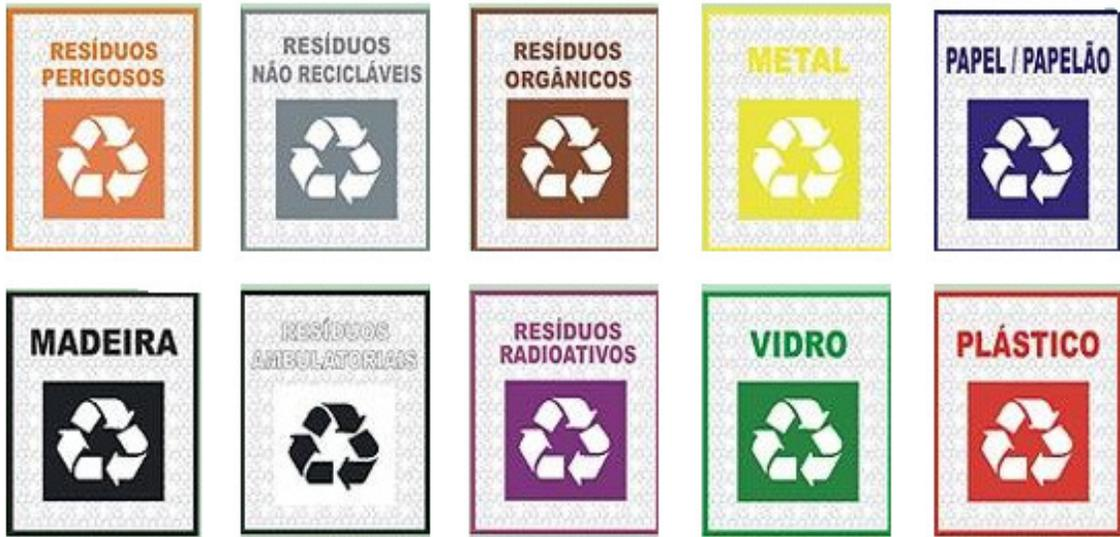
Figura 2.2 Identificação por cor de diferente tipo de material.
