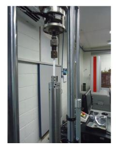
Figura 4.2: Ensaio de Tração
