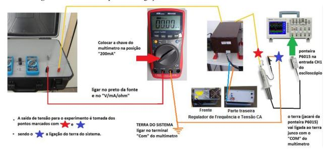
Figura 3.5: Esquema de ligação do circuito.
