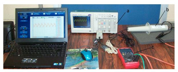
Figura 3.3: Foto do: a) osciloscópio; b) ponteira de alta tensão; c) múltimetro
