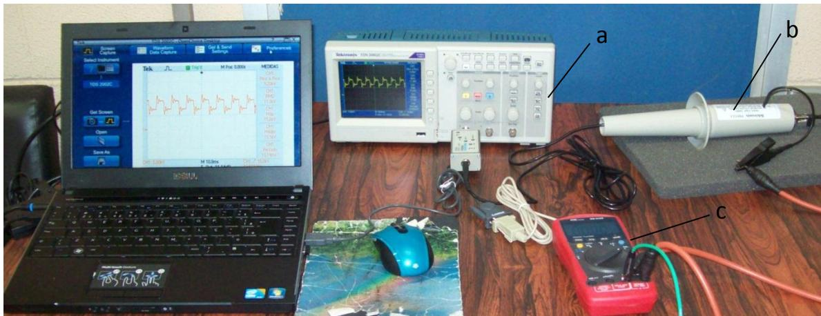
**Figura 3.3:** Foto do: a) osciloscópio; b) ponteira de alta tensão; c) multímetro
