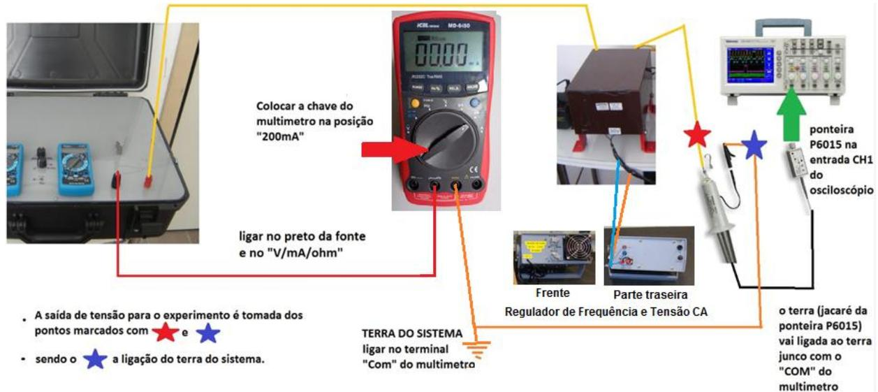
**Figura 3.5:** Esquema de ligação do circuito.
