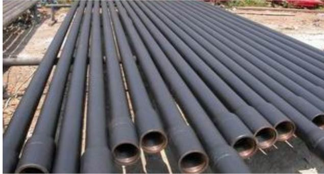
**Figura 2.3 Tubos pesados de perfuração (JAOilfield, 2006)**
