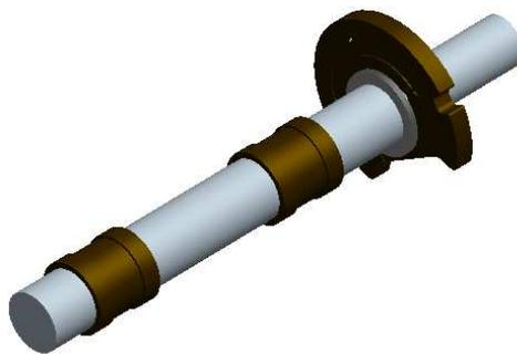
Figura 3.2: Conjunto montado com eixo, colar, mancais radiais e mancal axial
