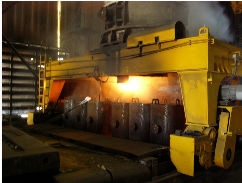
**Figura 3.3:** Lingotamento do aço.
