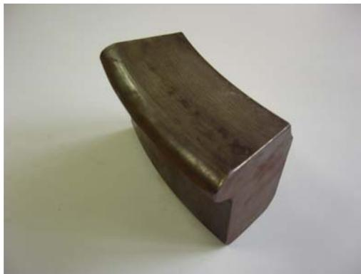
**Figura 4.11:** Peça de roda para determinar  $t_0$ .
