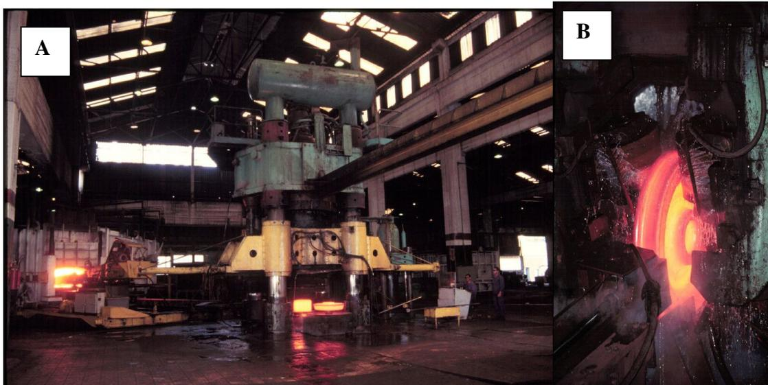
**Figura 3.6:** Forjamento e laminação das rodas.
