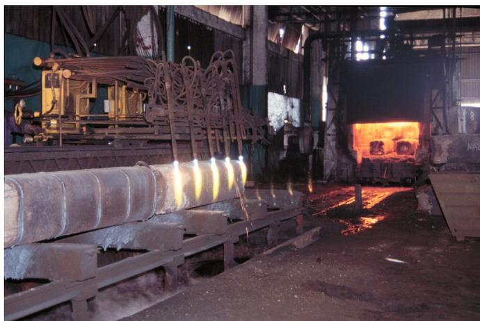
**Figura 3.5:** Corte dos blocos por oxicorte.
