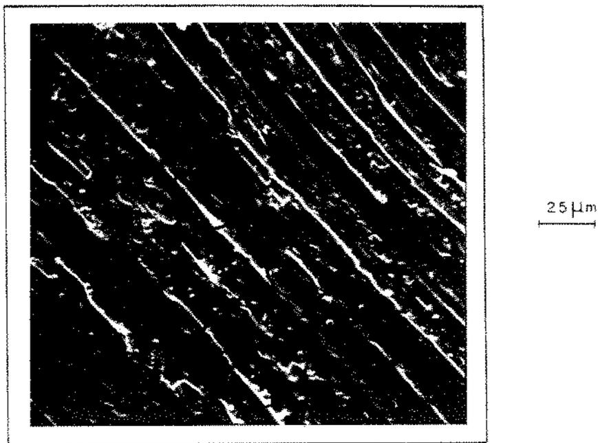
Figura 5.34 (a) Superfície desgastada na região central do pino de aço ABNT-1020 bifásico revenido a  $450^{\circ}\text{C}$ , sujeito a:
