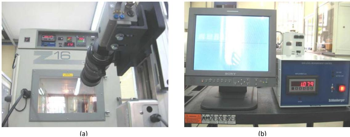
Figura 3.5 - Sistema de Medição de Nível: (a) câmera colorida de alta resolução direcionada para a célula PVT e (b) monitor colorido com o medidor de altura.
