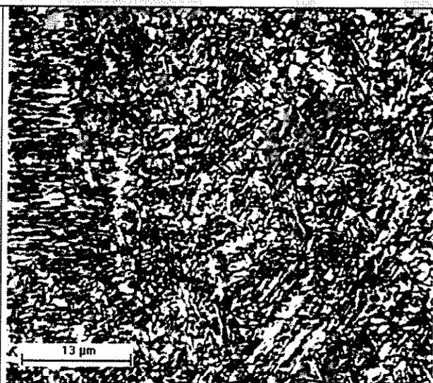
Figura 4.16: Peça C – 2, região cabeça (ataque Nital, 2%)
