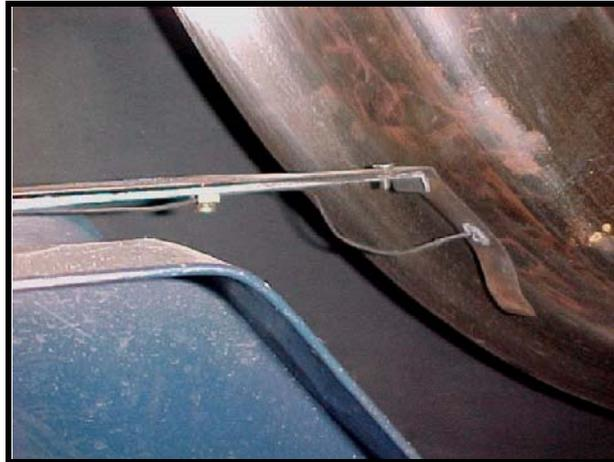
**Figura 4.5:** – Termopar deslizante.
