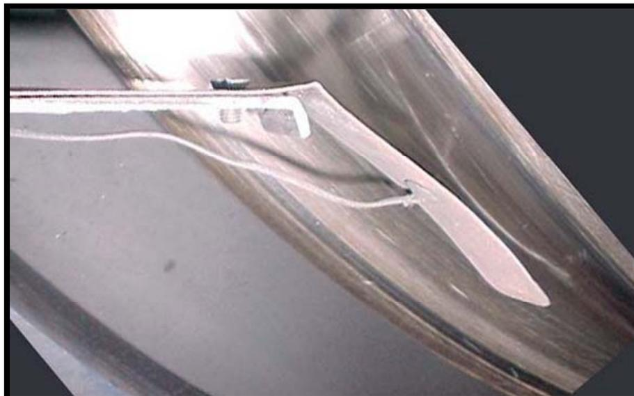
**Figura c.2:** - Lâmina metálica deslizante com termopar tipo K soldado utilizado durante o ensaio.
