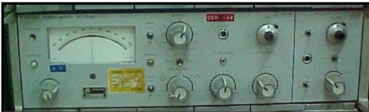
**Figura 4.10:** - Condicionador de sinais Phillips PR 9308.
