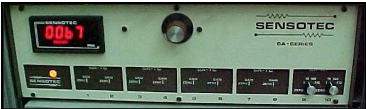
**Figura 4.8:** - Condicionador de Sinais SA-S com módulo Temperatura SA-TC e filtro AS-AF.
