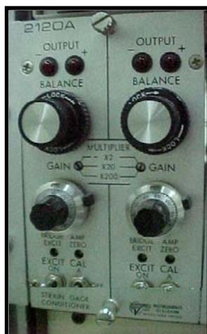
**Figura a.4:** – Módulo de medição do condicionador; o canal 2 é o da direita.
