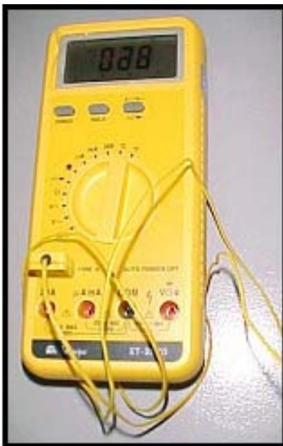
**Figura c.1:** - Conjunto de medição de temperatura multímetro- termopar calibrados.
