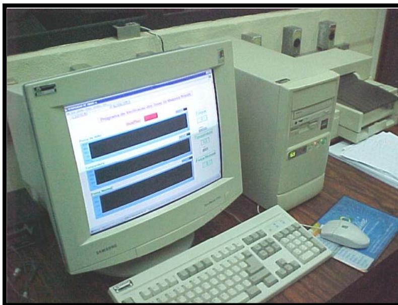
**Figura 4.9:** - Microcomputador Pentium I - 166 MHz.
