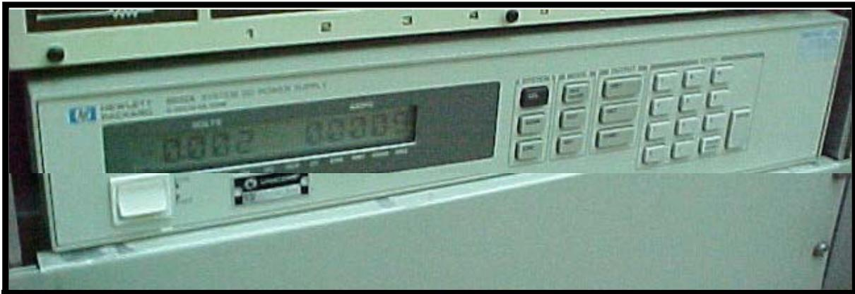
**Figura 4.7:** - Fonte de Tensão HP 6632A
