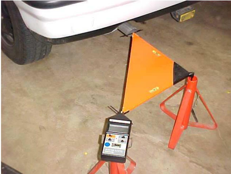
Figura 4 - Foto da Medição de Ruído - Decibelímetro – DNI/CT/UNICAMP
