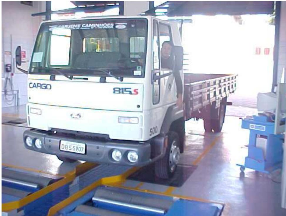
Figura 6 - Foto da Placa de Verificação de Alinhamento - DNI/CT/UNICAMP
