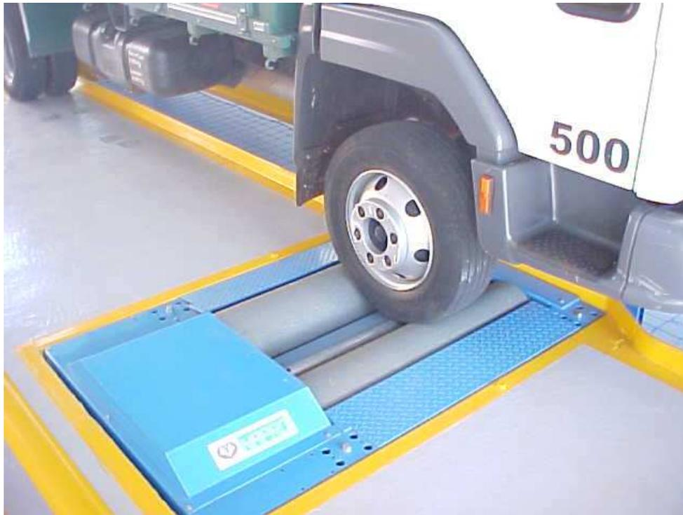
Figura 10 - Foto do Frenômetro - DNI/CT/UNICAMP
