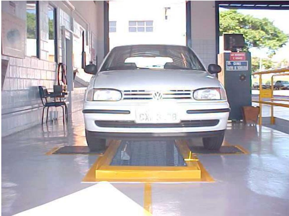
Figura 12 - Foto das Placas de Verificação de Folgas – DNI/CT/UNICAMP
