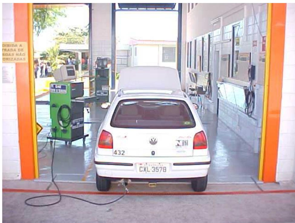
Figura 3 - Foto do Analisador de Gases – DNI/CT/UNICAMP
