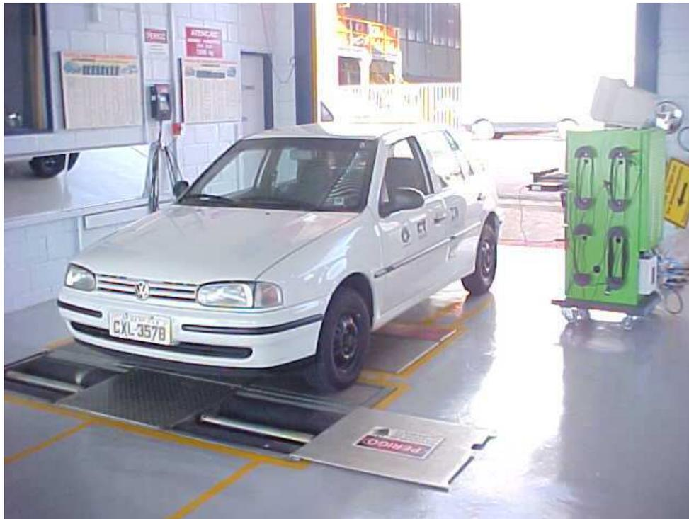
Figura 8 - Foto das Placas de Verificação de Suspensão – DNI/CT/UNICAMP
