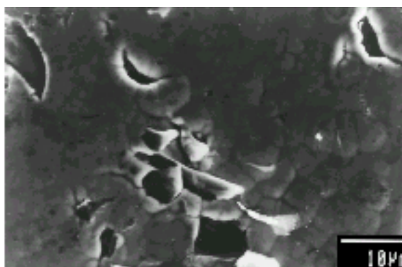
Figura 5.24: Morfologia da amostra de NiP com partículas de SiC( \varnothing = 8\mu\text{m} ) incorporadas obtidas na condição 7 da tabela 5.10 com tratamento térmico.
