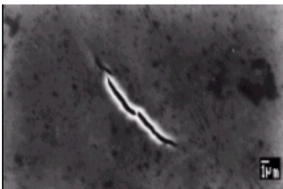
Figura 5.8: Morfologia do codepósito de NiP tratado termicamente à 400^\circ\text{C} .
