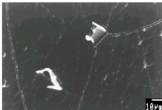
Figura 5.21: Detalhe das trincas iniciadas nas partículas de SiC incorporadas ao codepósito de NiP. Condições de deposição: \gamma = 80\% , i_m = 80 \text{ mA/cm}^2 e SiC com 20 \mu\text{m} de \varnothing .
