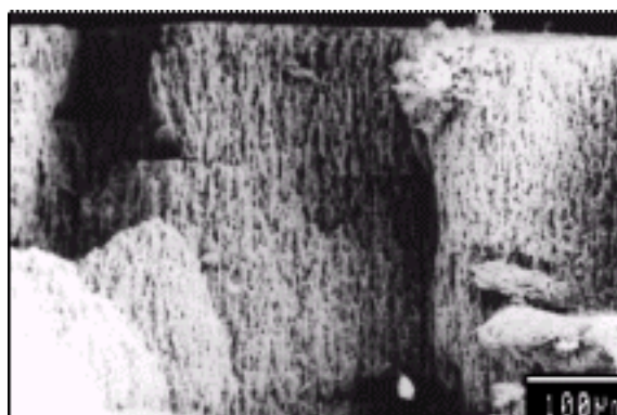
Figura 5.32: Morfologia da amostra de NiP com adição de partículas de \text{Al}_2\text{O}_3 e terras raras. Micrografia da seção transversal do revestimento
