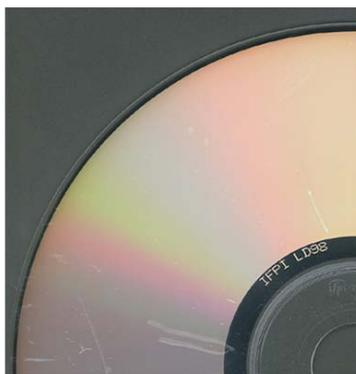
**Figura 7.1 - Ranhuras na camada de policarbonato**
