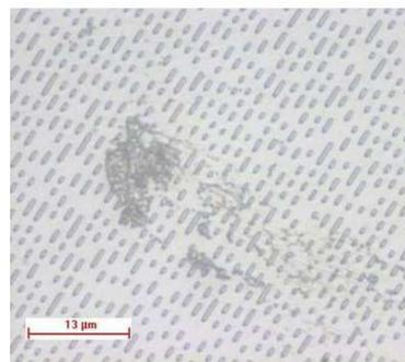
**Figura 4.13 - Imagem microscópica da falha do processo de metalização**
