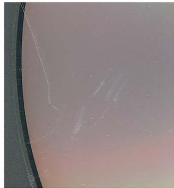
**Figura 4.4** - Ranhuras na camada de policarbonato **Figura 4.5** - Ranhuras na camada de policarbonato
