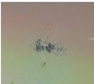
**Figura 4.12 - Falha no processo de metalização**
