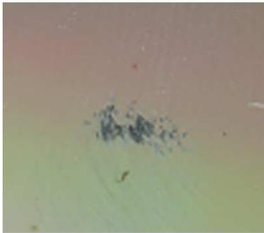
**Figura 7.3 - Falha na metalização**
