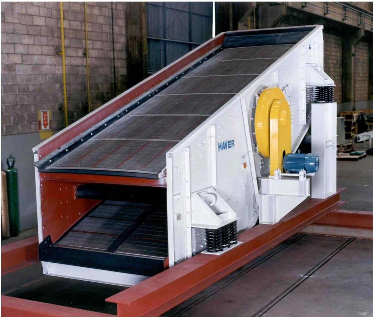
**Figura 2.7 – Peneira vibratória de acionamento livre linear**
