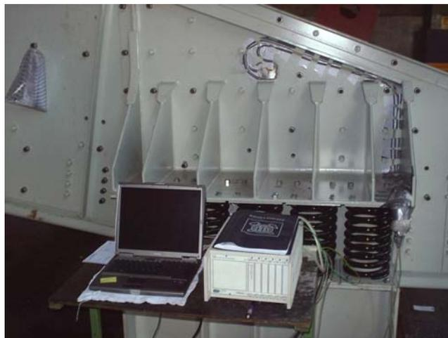
**Figura 5.27 – Sistema de aquisição de dados MGCplus**
