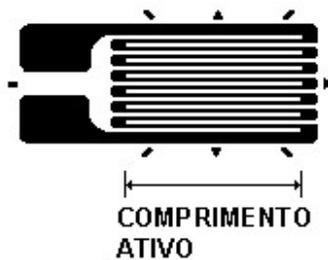
**Figura 4.2 – Comprimento ativo de um *strain gage* – Measurements group (1989)**
