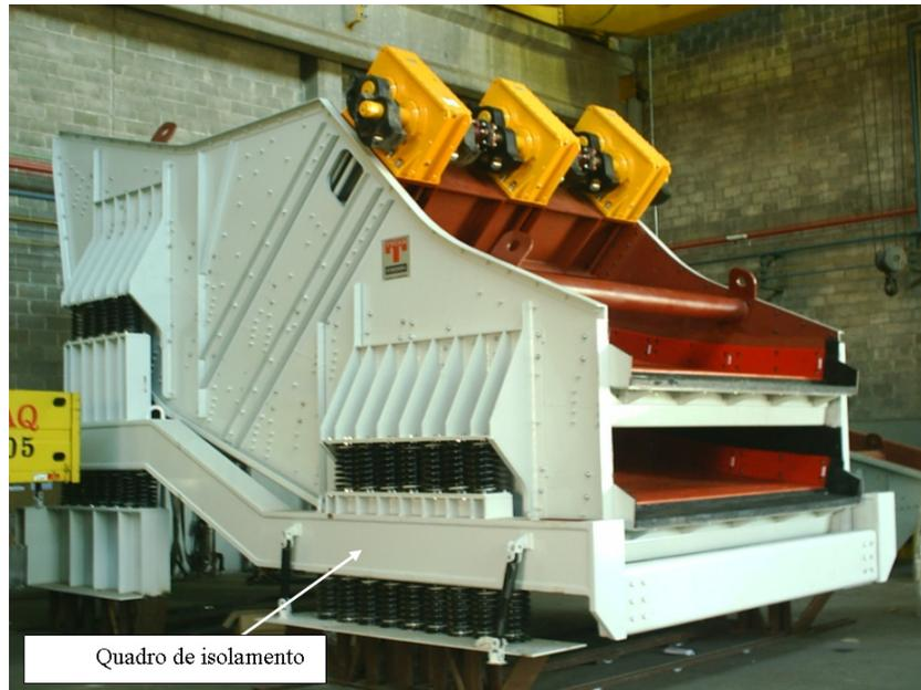
**Figura 2.24 - Peneira vibratória 3200 mm por 7315 mm com quadro de isolamento**
