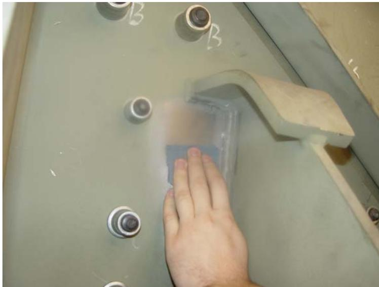
**Figura 5.21 – Etapa de lixamento da superfície analisada**
