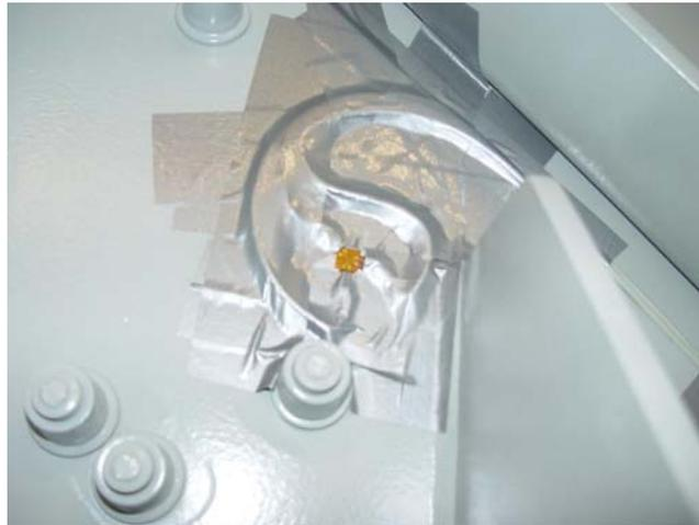
**Figura 5.26 – Acabamento do *strain gage***
