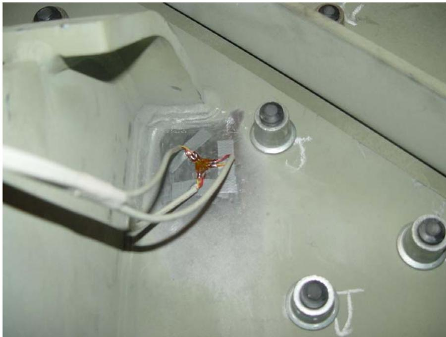
**Figura 5.25 – Colagem dos *strain gages***
