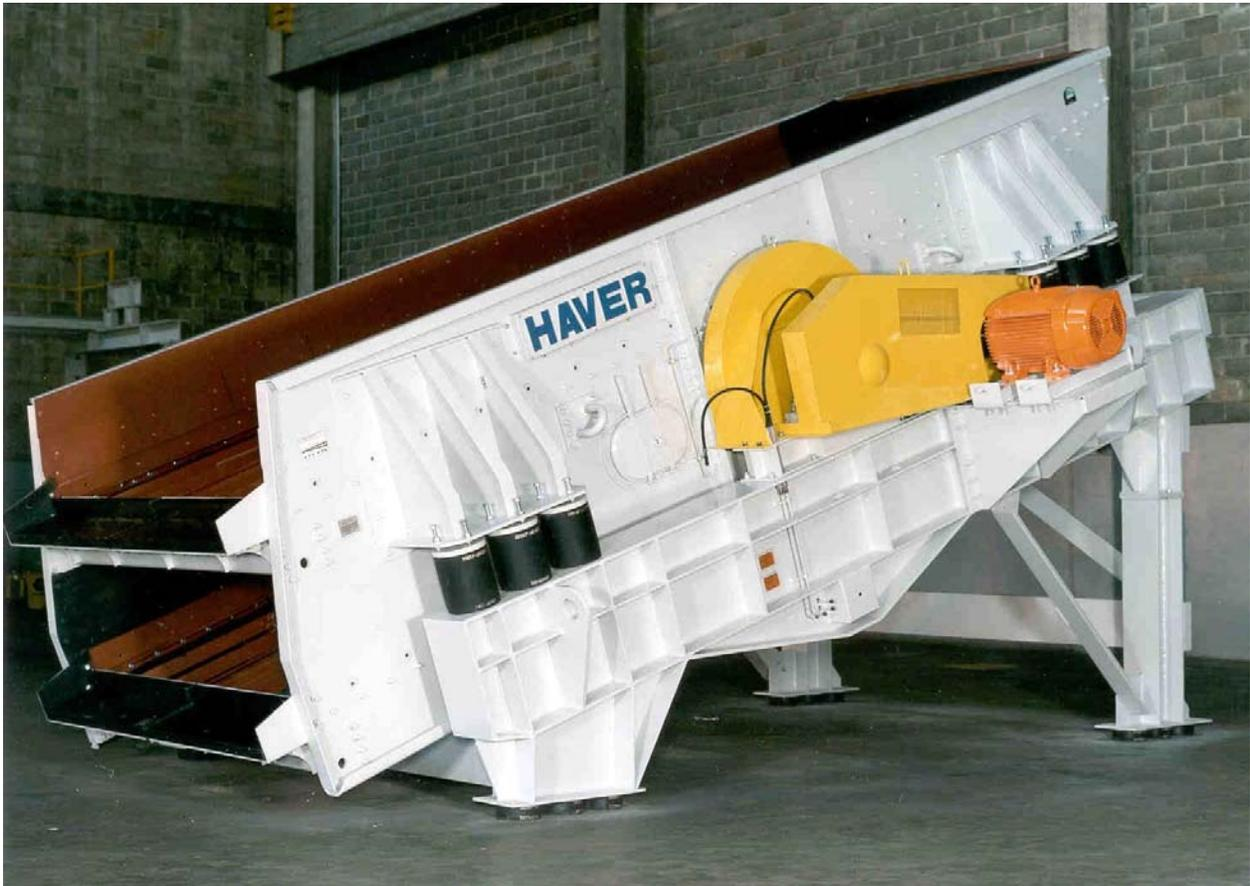
**Figura 2.9 – Peneira vibratória de acionamento excêntrico**
