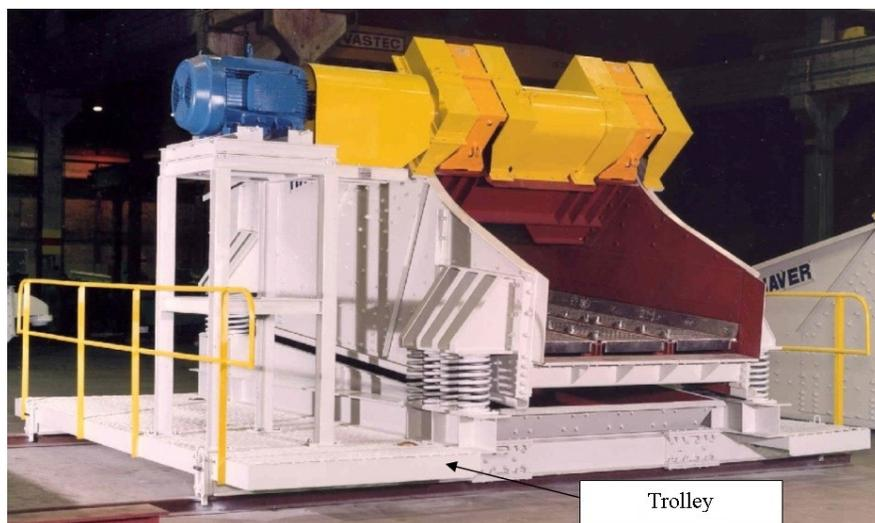
**Figura 2.25 - Peneira vibratória com Trolley de translação**
