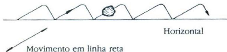
**Figura 2.6 – Movimento linear de uma partícula sobre a malha – Faço (1994)**
