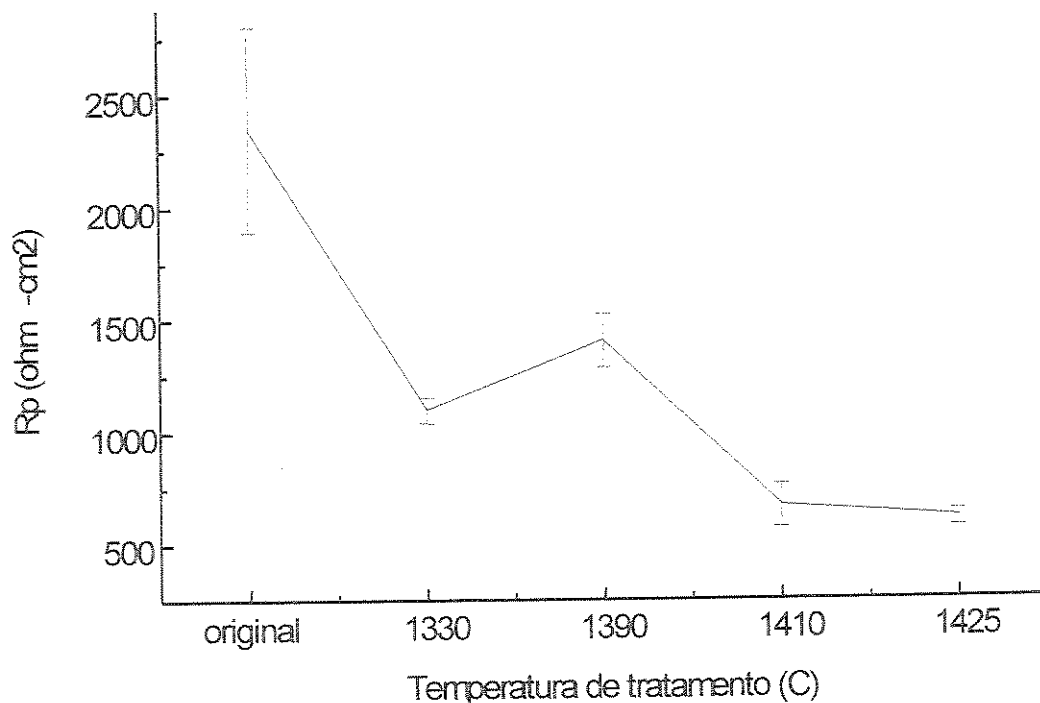
FIGURA 4.7 – Resistência de polarização R_p obtida após a polarização em solução de ácido sulfúrico das amostras do aço AISI 304 tratadas em diferentes temperaturas.
