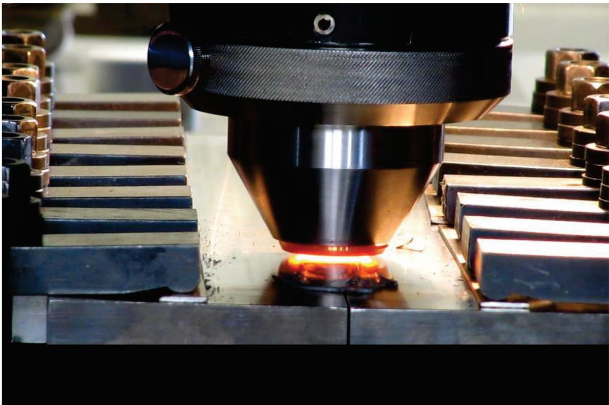
**Figura 3-5 - Foto ilustrativa do processo SAPNC realizado no Centro Nacional de Pesquisa em Energia e Materiais em barras de aço inoxidável supermartensítico (fonte: autor).**
