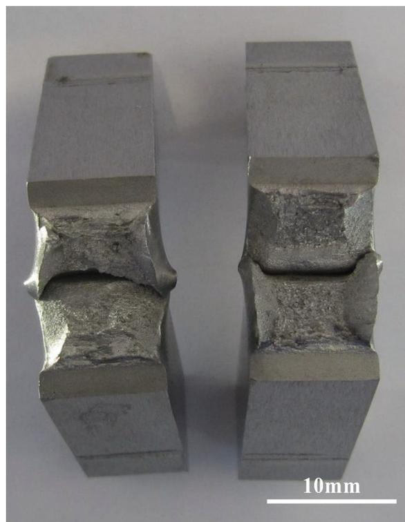
**Figura 5-14 - Corpos de prova Charpy de metal de base ensaiados a -20°C (fonte: autor).**
