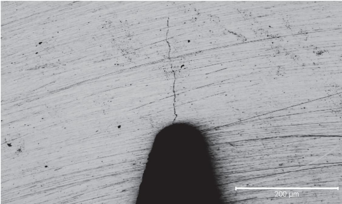
**Figura 4-17 - Detalhe da região trincada na raiz do entalhe de um corpo de prova de ensaio de tenacidade à fratura (fonte: autor).**
