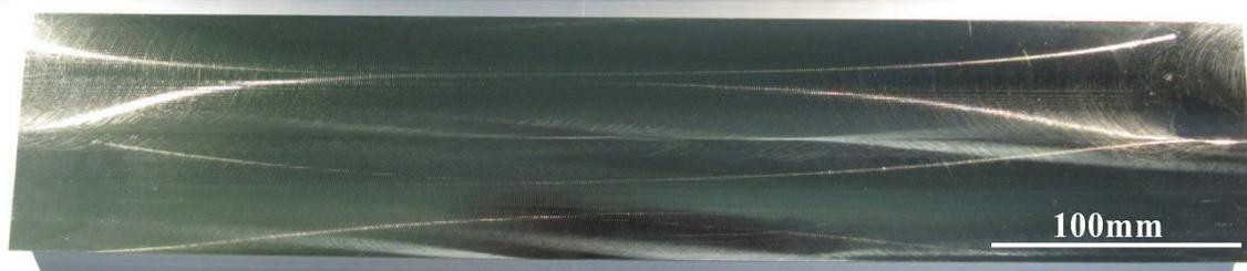
**Figura 4-3 - Aspecto geral da chapa de aço inoxidável supermartensítico após ser usinada, anteriormente ao processo de soldagem por fricção (fonte: autor).**
