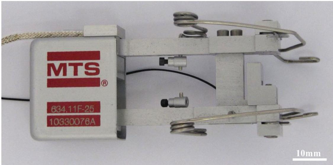
**Figura 4-23 – Extensômetro utilizado na medida de deformação da área útil de cada corpo de prova durante o ensaio de tração (fonte: autor).**
