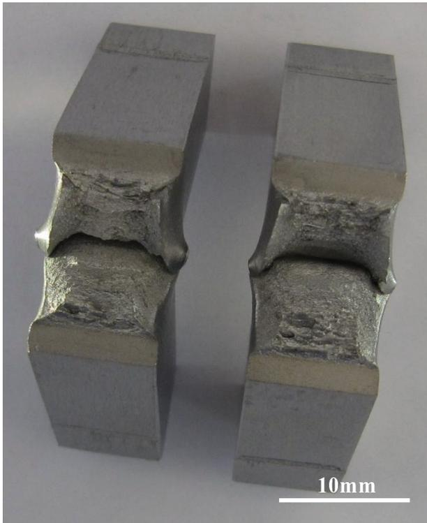
**Figura 5-10 -** Corpos de prova Charpy transversal e longitudinal após o ensaio a 20°C (fonte: autor).
