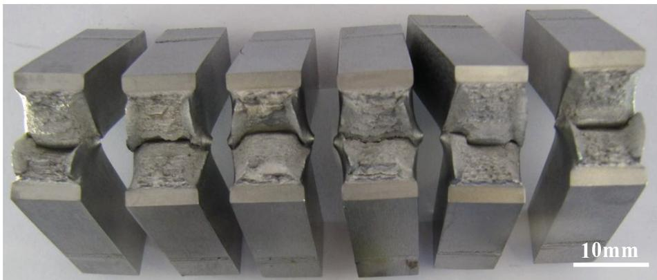
**Figura 5-12 -** Corpos de prova Charpy de metal de base ensaiados à temperatura de 0°C (fonte: autor).
