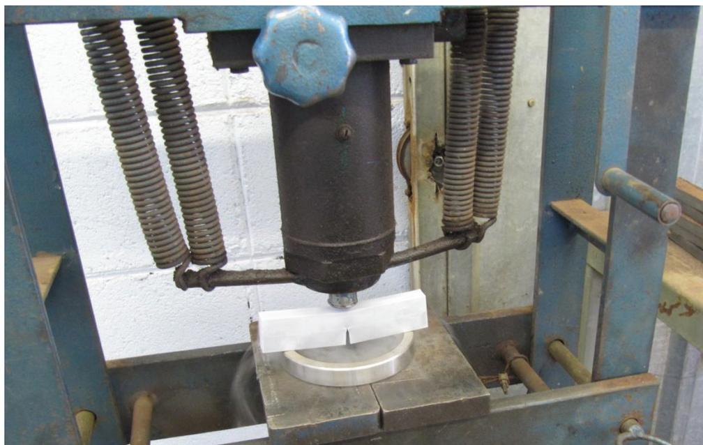
**Figura 4-34 - Flexão em três pontos em prensa hidráulica utilizada para o fraturamento frágil dos corpos ensaiados, com vista a permitir a medição de tamanho de pré-trinca de fadiga efetivo de acordo com as orientações da norma BS 7448 (fonte: autor).**
