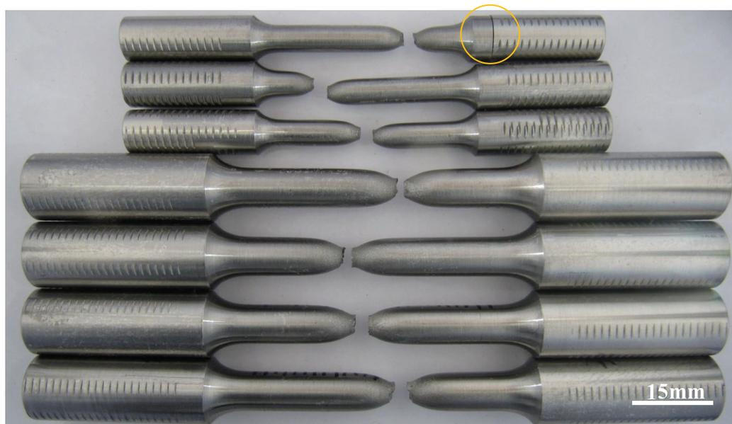
Figura 5-5 – Aspecto dos corpos de prova utilizados após os ensaios de tração padronizado realizados na temperatura de 0°C. Destaca-se a região onde houve o corte (círculo laranja) de uma das amostras para análise fractográfica (fonte: autor).
