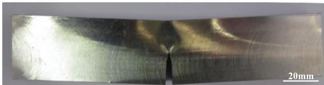
**Figura 4-31 – Aspecto típico geral do corpo de prova retangular em material base após o ensaio de tenacidade à fratura realizado (fonte: autor).**
