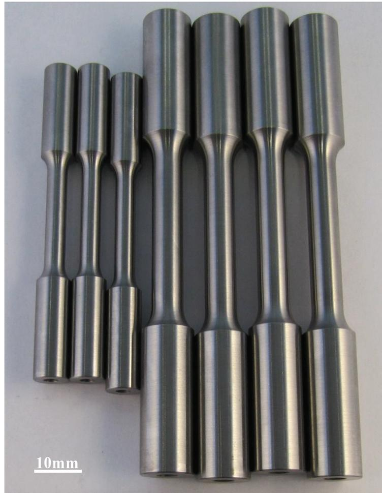
**Figura 4-20 - Corpos de prova de tração em aço inoxidável supermartensítico após usinagem. Os três corpos menores (à esquerda na figura) são aos corpos retirados na direção transversal à chapa, e os quatro corpos maiores (à direita na figura) retirados na direção longitudinal à mesma (fonte: autor).**
