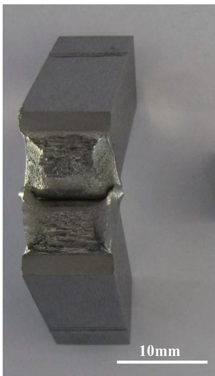
**Figura 5-13 - Corpo de prova Charpy de metal de base ensaiado a -10°C (fonte: autor).**
