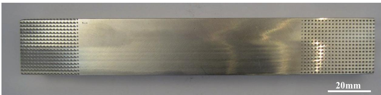
**Figura 4-24 – Aspecto de corpo de prova utilizado para medição do coeficiente de Poisson do material de estudo, após o respectivo ensaio padronizado (fonte: autor).**
