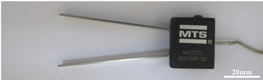
**Figura 3-14 - Clip Gage utilizado para medição do valor de CMOD (fonte: autor).**
