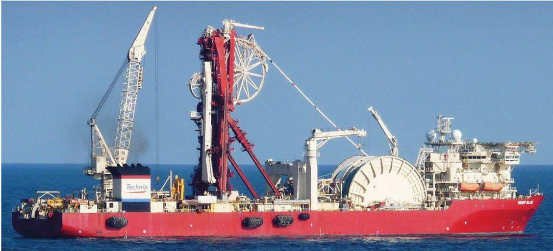
**Figura 3-2 – Navio de lançamento de dutos pelo método de lançamento *reeling*, também chamado de *carretel* (WIKIMEDIA COMMONS, 2013).**
