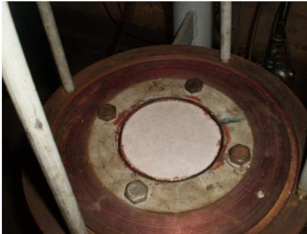
Figura 3.5 – Distribuidor de gás tipo placa poroso apoiado sobre a base do tubo do vidro
