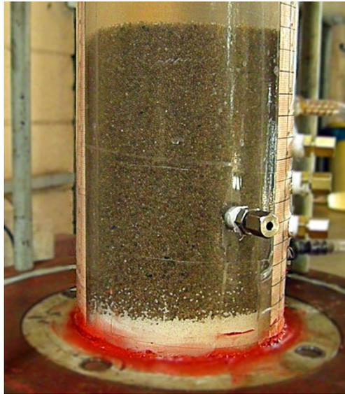
Figura 4.1 – Leito carregado com mistura (*PL-VG*) antes de iniciar o teste.
