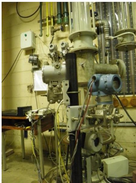
Figura 3.13 – Fotografia da coluna de manômetros ao lado do sistema experimental
