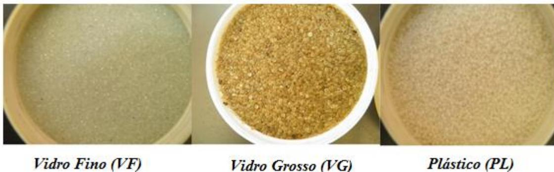
Figura 3.1- Fotografias das microesferas de vidro fino, vidro grosso e plástico.
