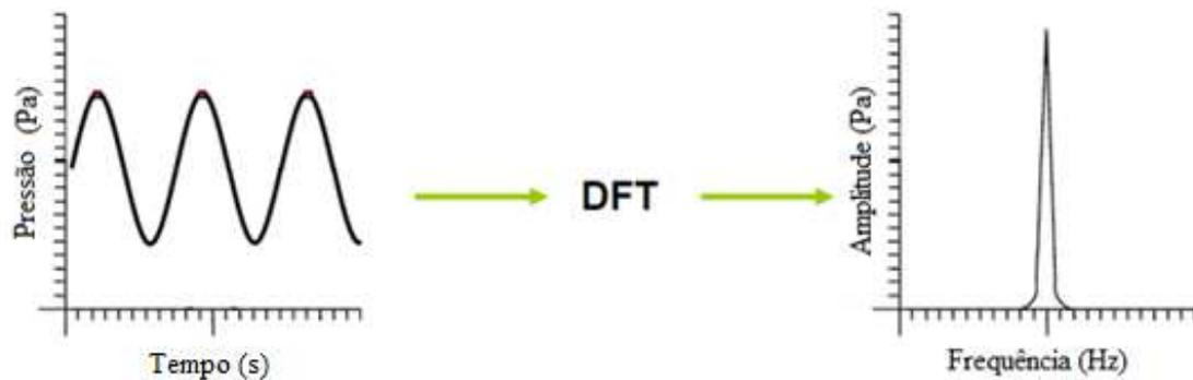
Figura 2.5 - Esquema representativo da transformada discreta de Fourier
