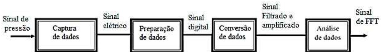
Figura 2.2 - Etapas de aquisição e processamento de sinais
