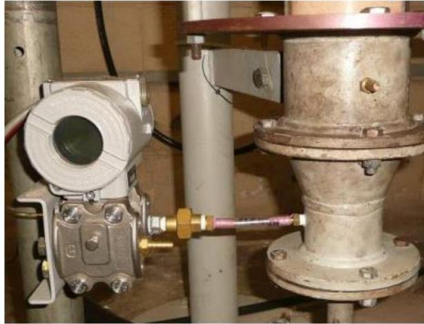
Figura 3.9 – Transdutor de pressão Smar LD-301 D2 conectado ao *plenum* do sistema experimental.
