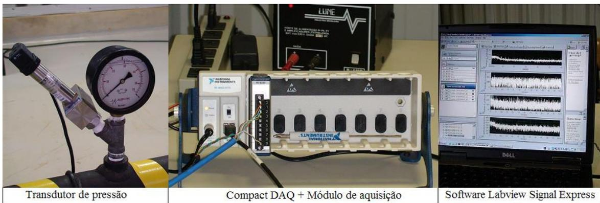
Figura 5.4. Sistema de aquisição de sinais.
