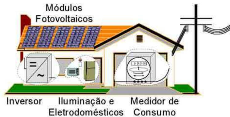
Figura 2.21 Esquema de um SFCR descentralizado.
