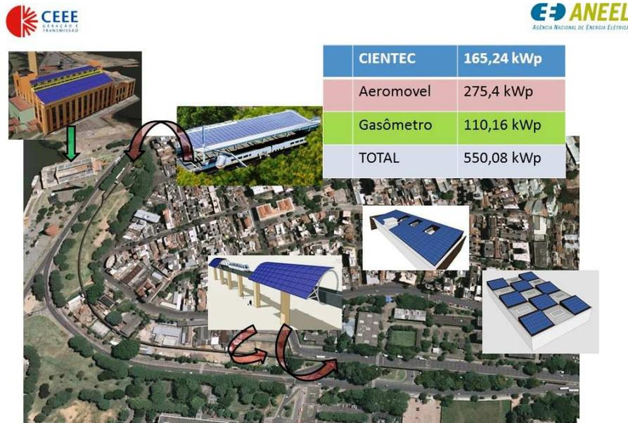
Figura 4.20 Disposição dos módulos solares no Projeto da CEEE-GT.
