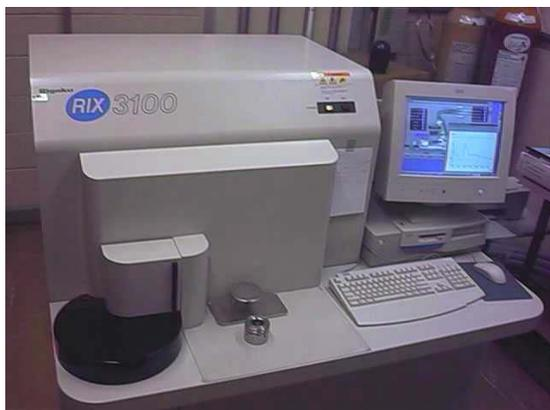
Figura 3.10. Espectrômetro de fluorescência de raios-X, RIX3100.
