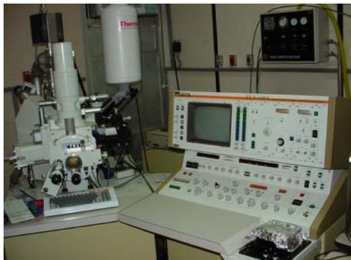
Figura 3.12. Microscópio Eletrônico de Varredura, JEOL JXA 840A.
