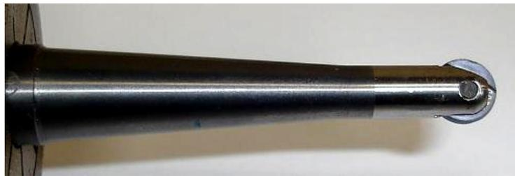
**Figura 4.7 – Inserto esférico (R = 4 mm), utilizado na usinagem de acabamento.**
