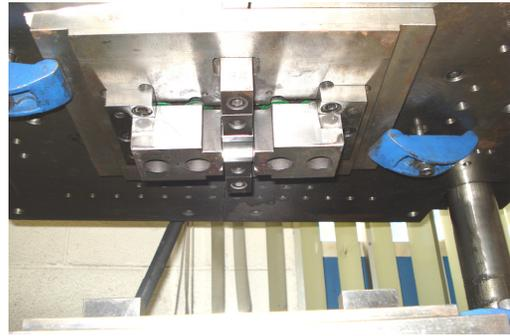
Figura 4.21 – Ferramental montado na prensa. Conjunto Inferior (a) e conjunto superior (b).
