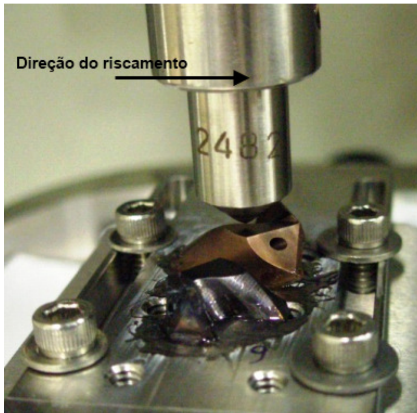
Figura 3.5 – Montagem das amostras para ensaio de riscamento.
