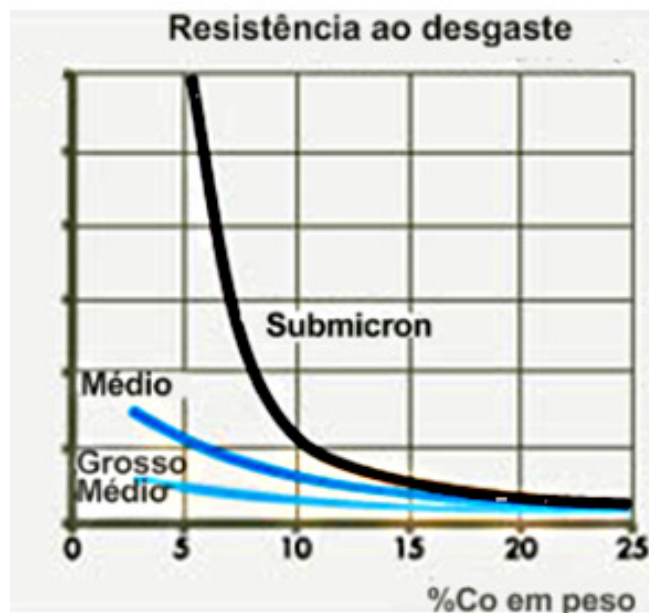
Figura 2.2 – Resistência ao desgaste do metal duro em função do teor de cobalto e do tamanho do grão (Sandvik, 2008 - modificado).
