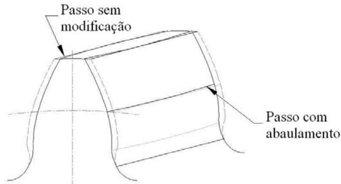
Fig. 1.5: Ilustração do abaulamento do passo da hélice.
