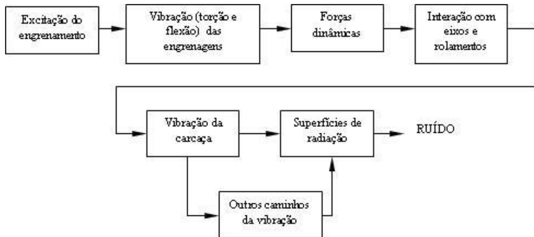
Fig. 1.2: Fluxo de vibração e ruído de uma caixa de engrenagens.
