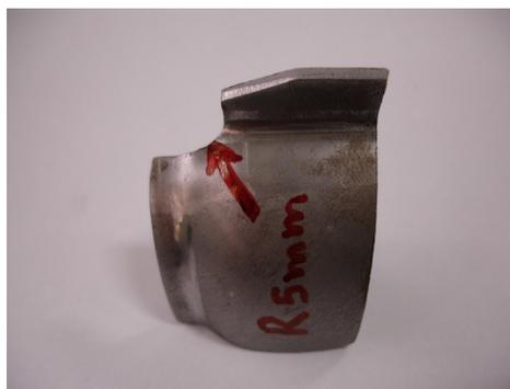
Figura 3.3. Raio de curvatura final
