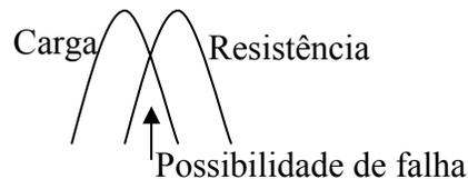
Figura 2.24. Princípio da técnica de interface carga-resistência
