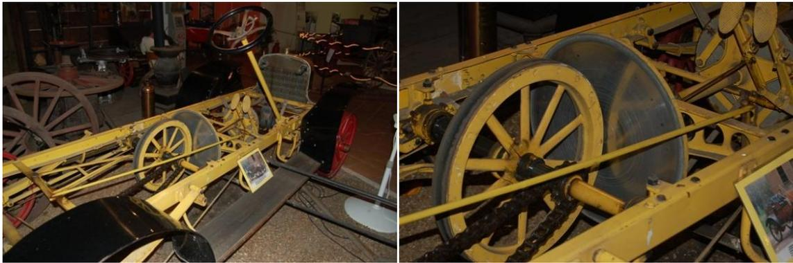
**Figura 5: CVT do tipo “Friction Disk” e um CarterCar, modelo de 1908 (Troeger, 2009).**
