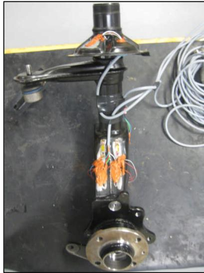
**Figura 5.3:** - Fixação dos extensômetros na manga de eixo.
