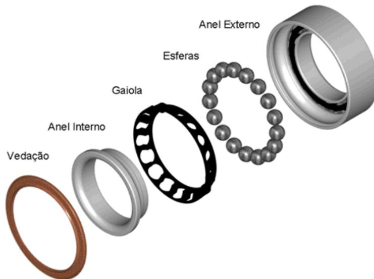
**Figura 2.3:** - Vista explodida de um rolamento de rodas de primeira geração (FAG, 2003).
