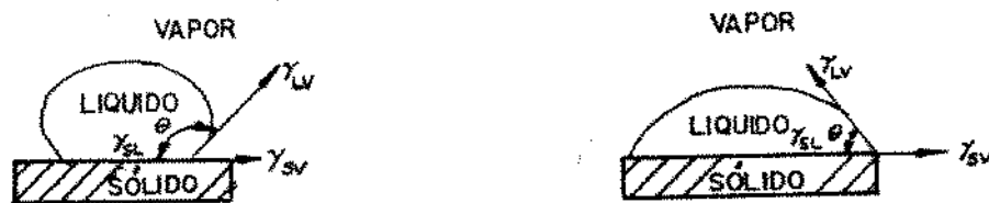
Fig 3.2 - (a) Esferoidização (b) Molhamento [15]
