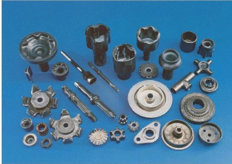
Figura 2.12 – Produtos obtidos por processos de deformação plástica: a frio, morno e quente.
