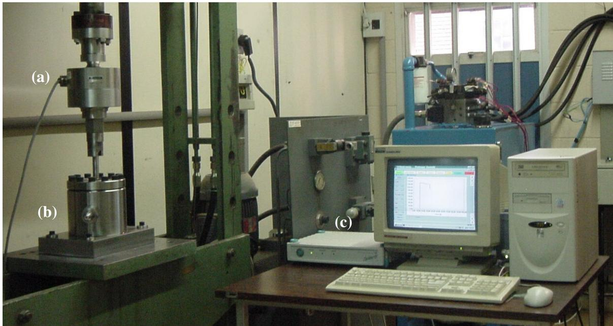
Figura 3.10 – Sistema de aquisição de dados: a) Célula de carga;
